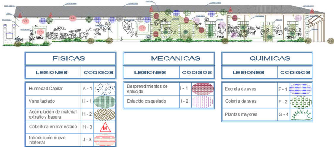
Figura 87: Patologías en fachada este.
