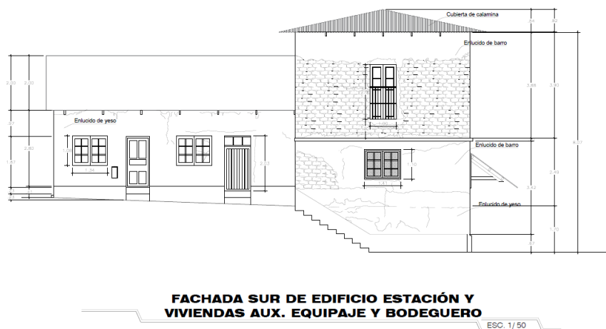
Figura 70: Fachada sur del edificio estación y viviendas aux. Equipaje y bodeguero.
