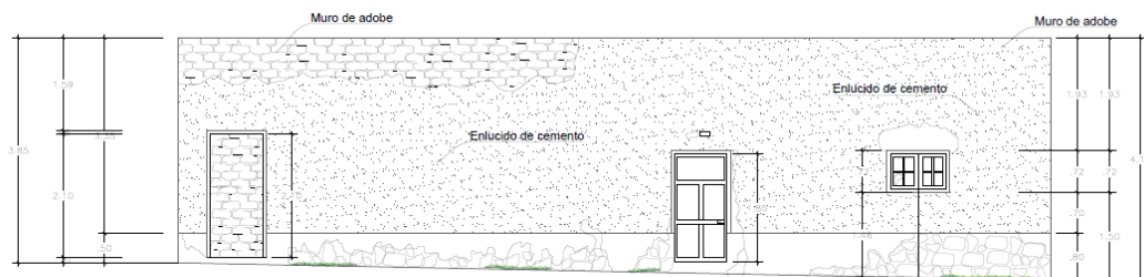
FACHADA OESTE - VIVIENDA PEON TRAFICO 01 Y ESTANQUERO 02
