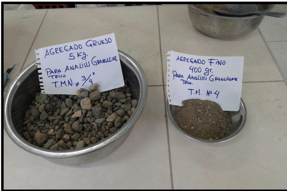
Figura N° 04: Se observa agregado grueso y fino para análisis granulométrico
