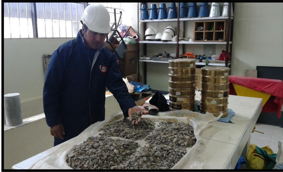
Figura N° 03: Se observa el cuarteo del agregado grueso.
