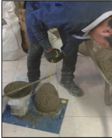
Figura 14. Ensayo de asentamiento cono de Abrams.
