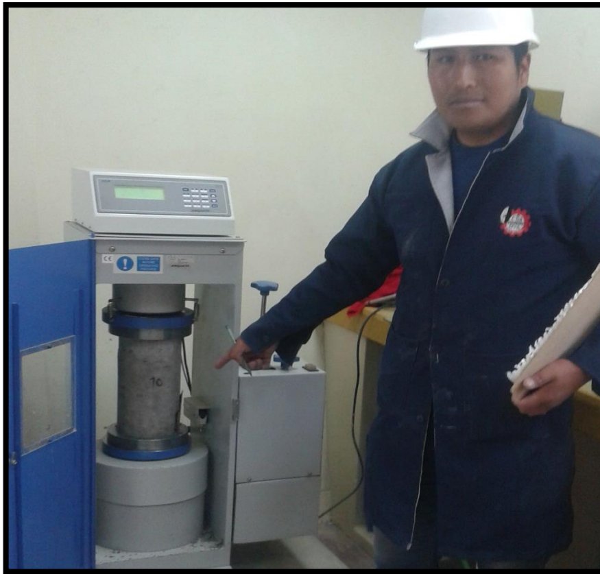
Figura N° 09: Ensayo de resistencia a la compresión del concreto con sustitución parcial al cemento por nanosílice.
