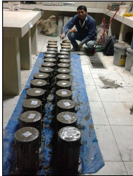
Figura 12 Llenado de moldes y apisonado de mezcla de concreto en tres capas iguales y luego su respectiva codificación.
