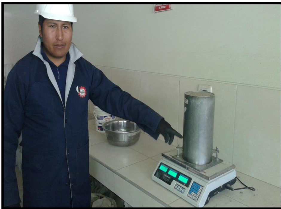
Figura N° 06: Ensayo de peso unitario suelto y compactado del agregado fino.
