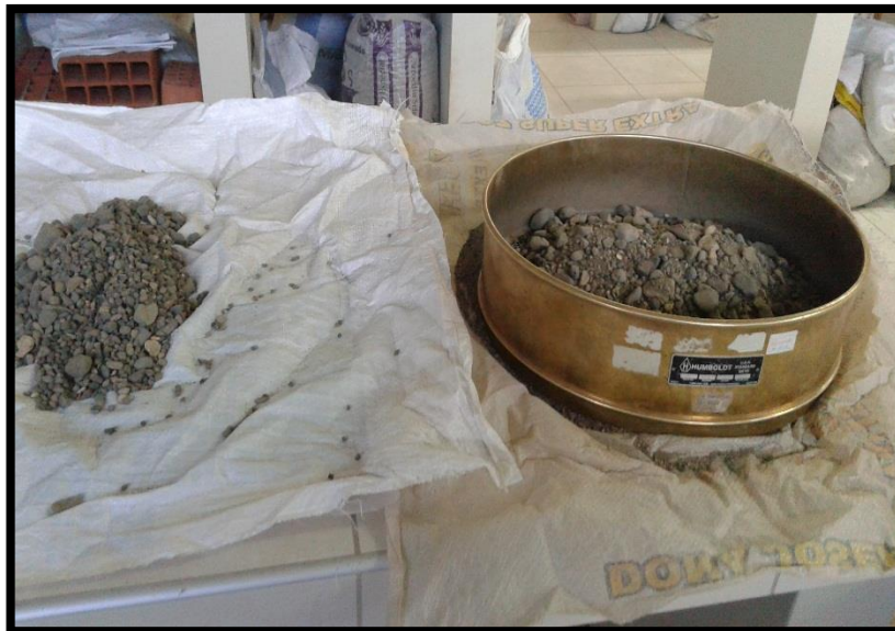
Figura N° 02: Se observa la separación del agregado fino y grueso con el tamiz N° 4.
