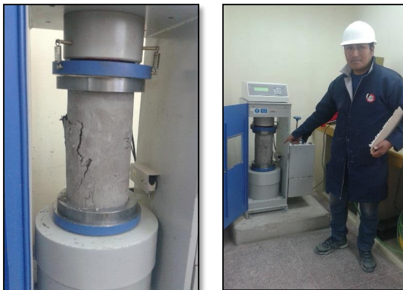
Figura 15. Ensayo de resistencia a compresión.
