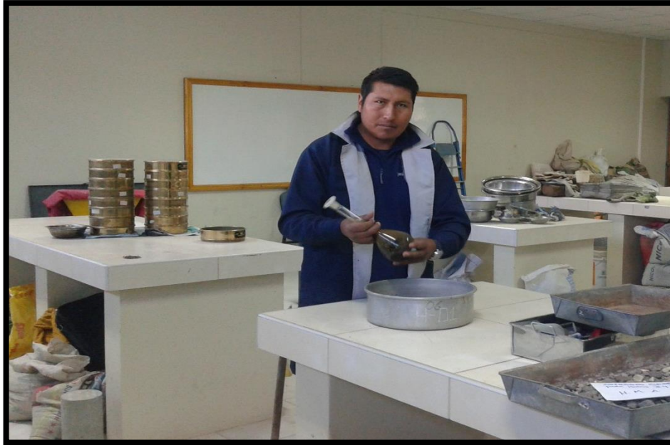
Figura N° 05: Se observa el ensayo del peso específico del agregado fino.
