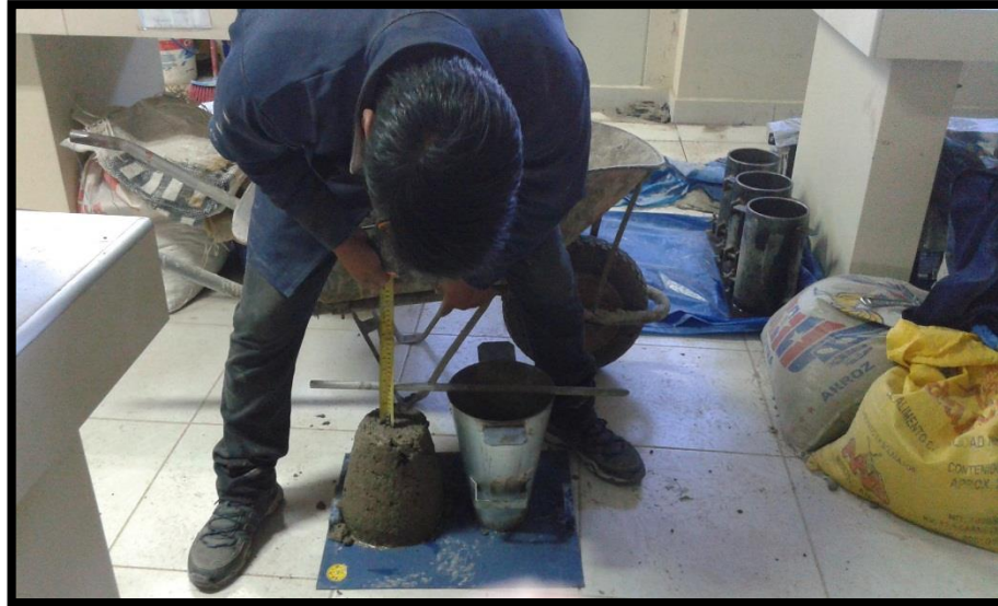
Figura N° 07: Medida de revenimiento de la mezcla de concreto patrón.
