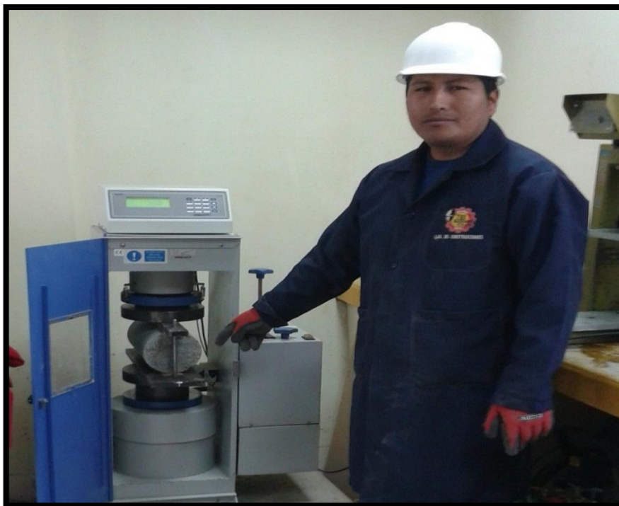
Figura N° 10: Ensayo de resistencia a tracción por compresión diametral del concreto con sustitución parcial al cemento por nanosílice.
