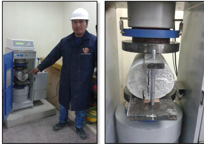
Figura 16 Ensayo de resistencia a la tracción por compresión diametral.
