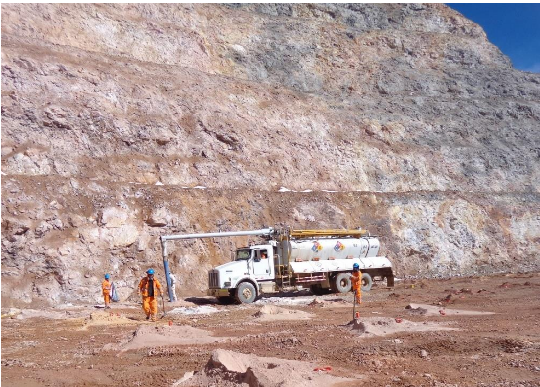
Figura 16. Carguío de taladros con Heavy Anfo - Camión Fabrica
