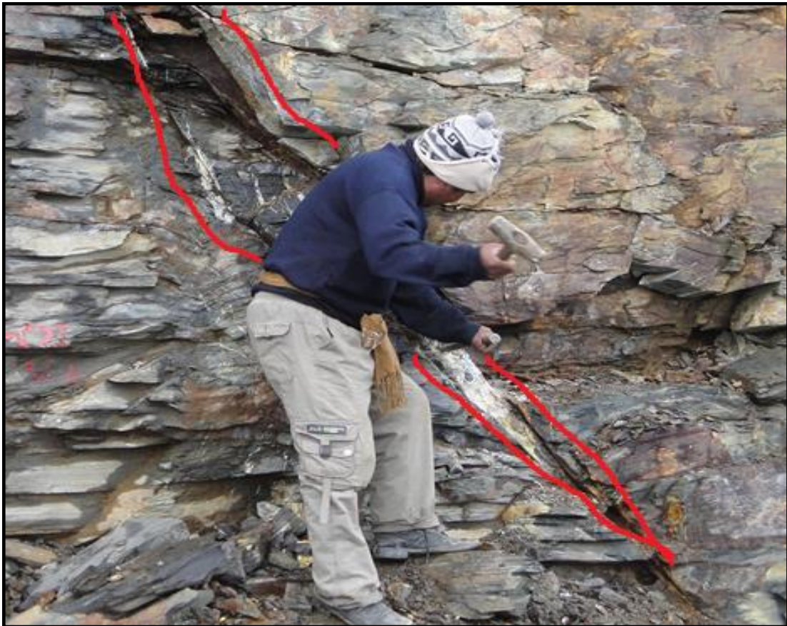
Figura 18. Muestreo en estructura mineralizada para estudio microtermométrico.
