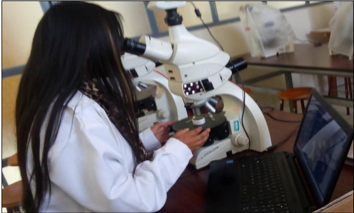
Figura 23. Estudio mineragráfico con el microscopio Leica y toma de micrografías en el software LAS EZ.
