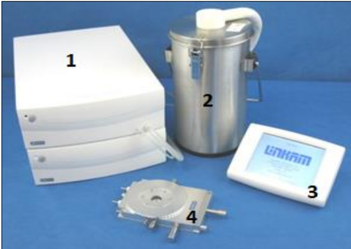
Figura 24. Componentes del equipo de inclusiones fluidas LINKAM.
