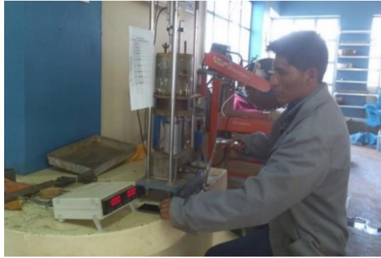
Figura 49: Lectura de dial de penetración de muestra tratada con cloruro de calcio
