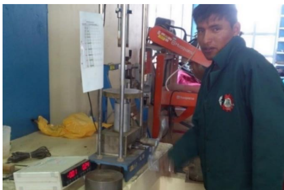
Figura 52: Lectura de dial de penetración de muestra tratada con aceite sulfonado
