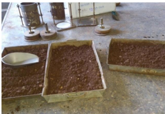
Figura 50: Preparación de muestra tratada con aceite sulfonado
