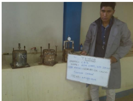
Figura 48: Lectura de dial de expansión de muestra tratada con cloruro de calcio
