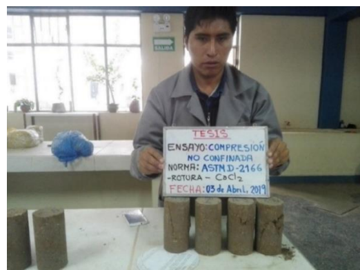
Figura 70: Rotura de las muestras dosificadas con CaCl 2 a compresión siempre
