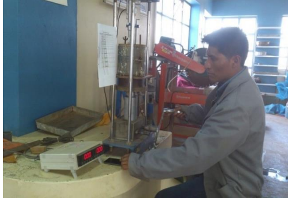
Figura 46: Lectura de dial de penetración del ensayo de CBR
