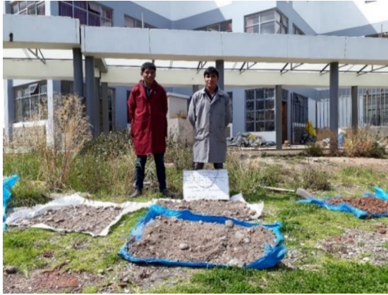
Figura 21: Secado de material de la cantera Challacollo para granulometría
