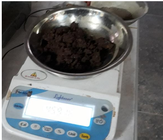
Figura 40: Muestra para contenido de humedad del ensayo de Proctor modificado
