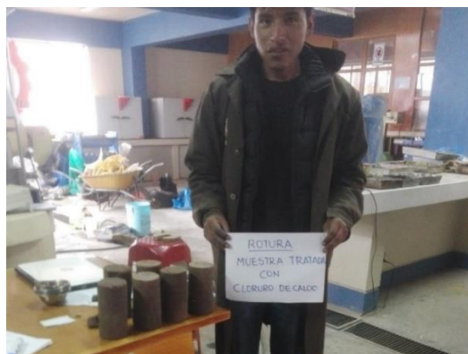
Figura 65: Muestra tratada con cloruro de calcio sometida a compresión
