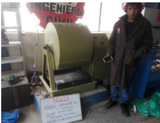
Figura 62: Muestra de cantera Chipana sometida a abrasión
