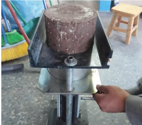
Figura 39: Extracción de muestra para el contenido de humedad
