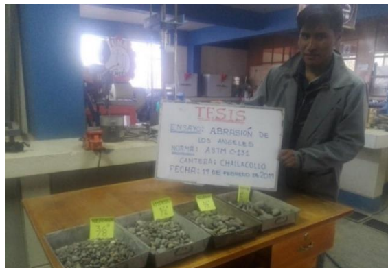
Figura 57: Pesado de muestra a 1250 kg para abrasión
