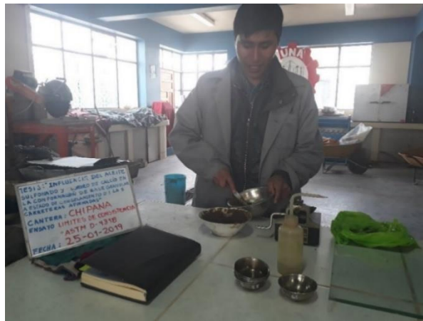
Figura 26: Saturación de muestra para ensayos de LL y LP
