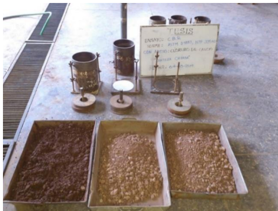
Figura 47: Preparación de muestras tratadas con cloruro de calcio
