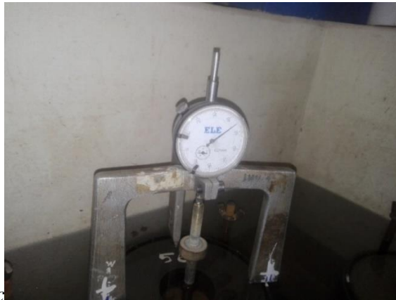
Figura 45: Lectura de dial de expansión del ensayo de CBR
