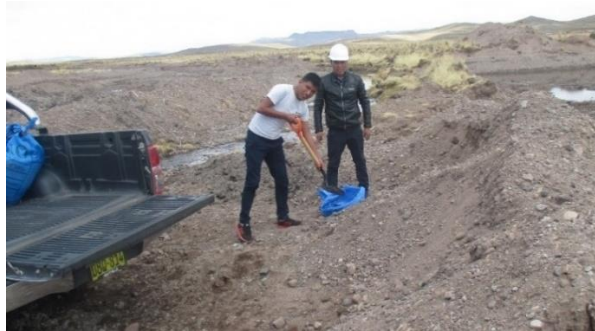
Figura 19: Muestreo de material en la cantera Challacollo
