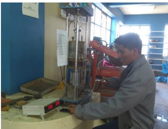
Figura 56: Lectura de dial de penetración muestra diseño tradicional
