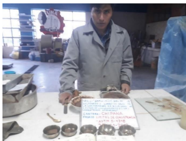
Figura 28: Muestras para contenido de humedad del ensayo LL y LP
