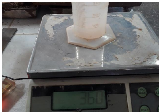
Figura 34: Contenido de agua para el ensayo de Proctor modificado
