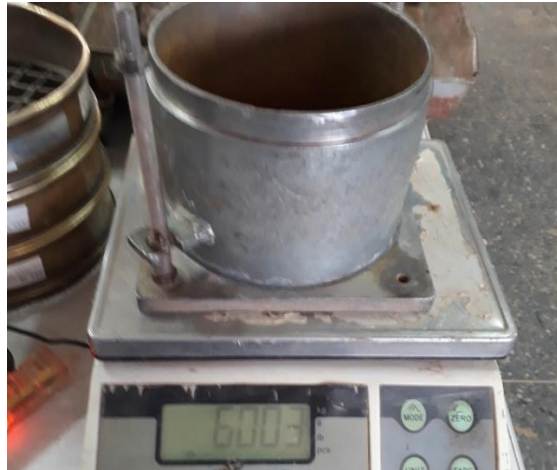
Figura 35: Peso del molde de Proctor modificado
