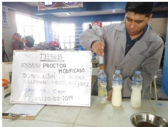
Figura 42: Dosificación de aceite sulfonado de 0.15%, 0.30%, 0.50%
