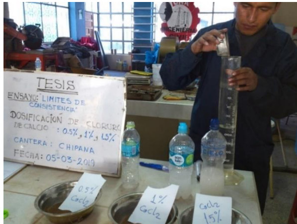
Figura 29: Dosificación de cloruro de calcio para límites de consistencia
