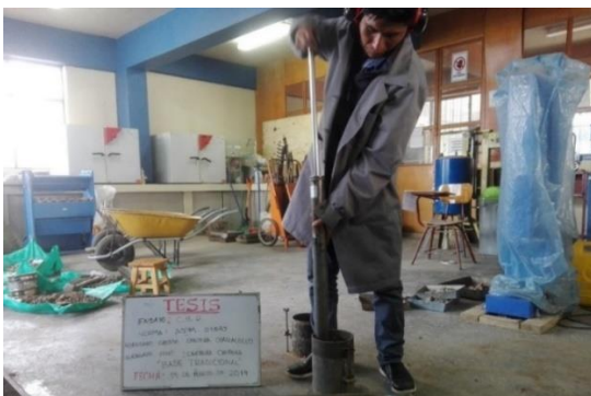
Figura 54: Compactación para CBR de la muestra diseño tradicional
