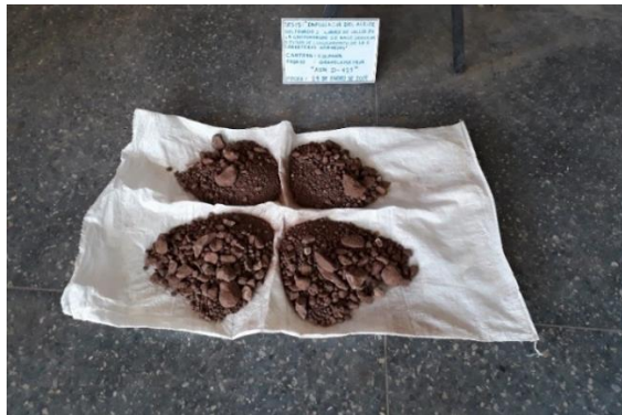
Figura 23: Cuarteo de la muestra de la cantera Chipana
