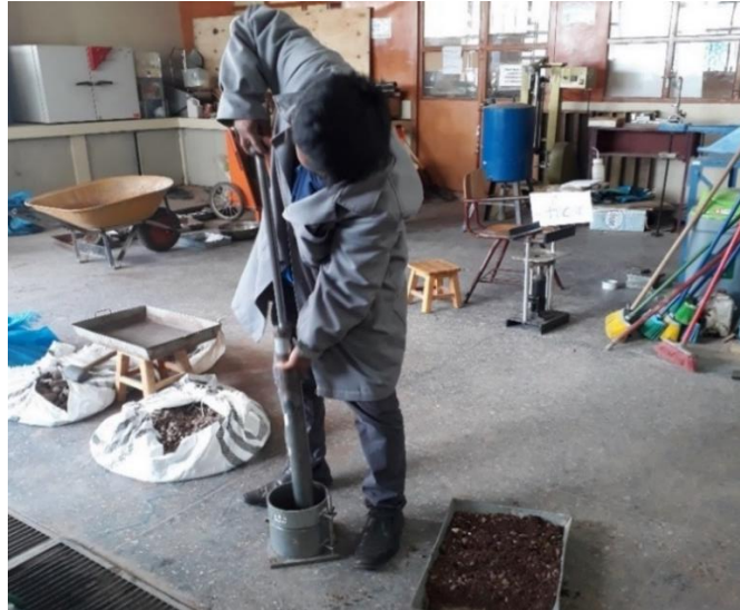
Figura 37: Compactación por capas para el ensayo de Proctor modificado
