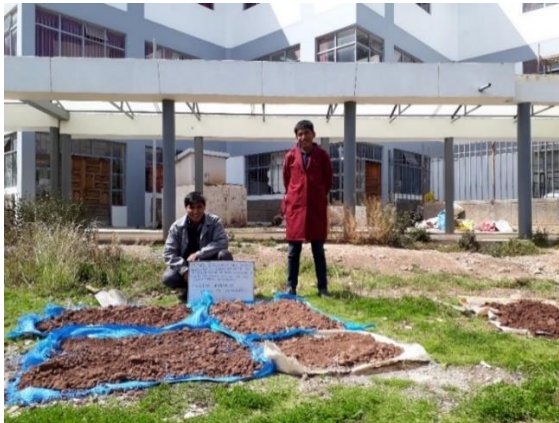
Figura 22: Secado de material de la cantera Chipana
