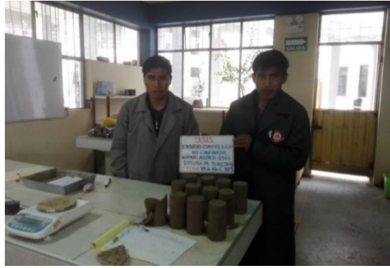
Figura 71: Muestras congeladas sometidas a compresión
