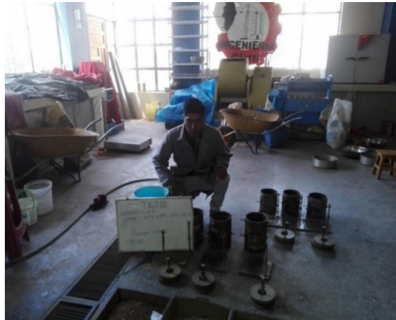
Figura 44: Preparación de muestras para el ensayo de CBR
