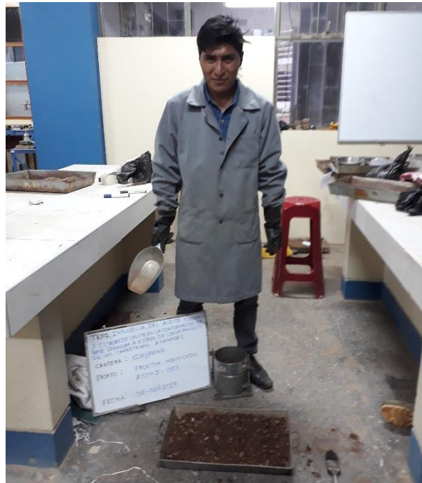
Figura 36: Saturación de muestra para el ensayo de Proctor modificado
