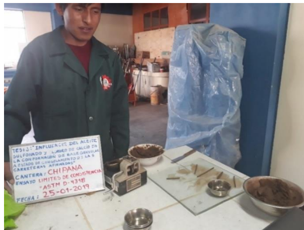
Figura 27: Ensayo de límites de consistencia
