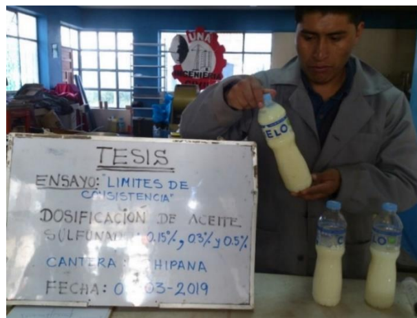
Figura 30: Dosificación de aceite sulfonado para límites de consistencia
