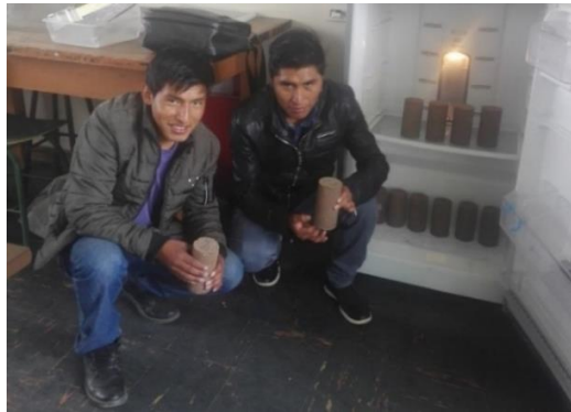
Figura 67: Congelamiento de muestras a -7.15\text{ }^{\circ}\text{C} .
