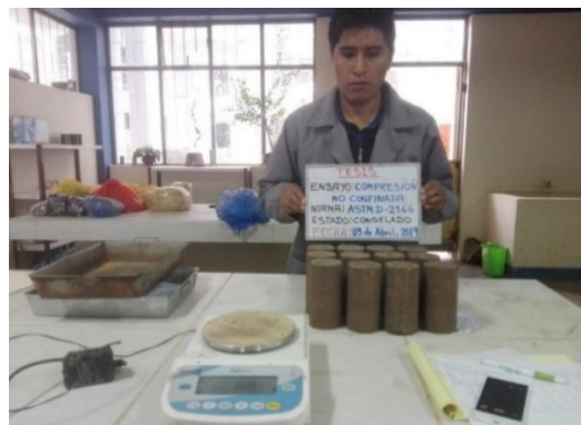
Figura 68: Muestras congeladas para ser sometidas a compresión simple
