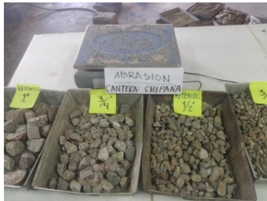
Figura 60: Muestra para abrasión de cantera Chipana
