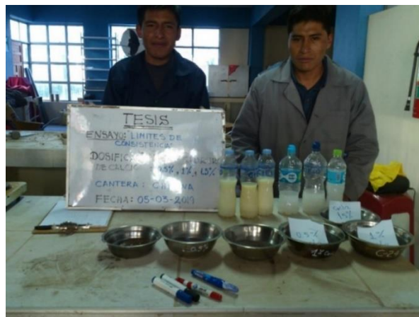
Figura 31: Saturación de muestra con líquido tratado con aditivos
