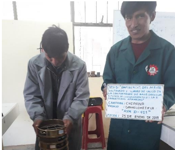
Figura 25: Tamizado de la muestra cantera Chipana
