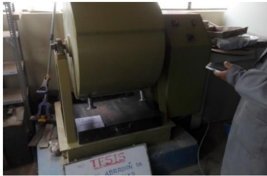
Figura 59: Muestra sometida a abrasión de cantera Challacollo
