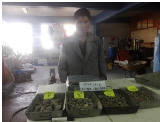
Figura 61: Muestra pesada a 1250 kg para abrasión
