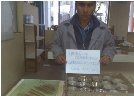
Figura 33: Límites de consistencia con aditivo cloruro de calcio
