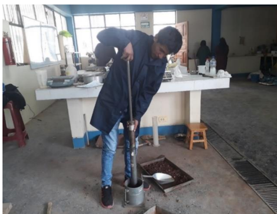
Figura 43: Compactación por capa de muestras tratadas con aditivos
