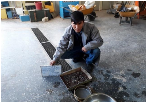
Figura 24: Lavado de muestra cantera Chipana
