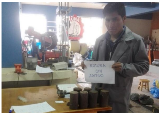
Figura 64: Muestra no tratada sometida a compresión
