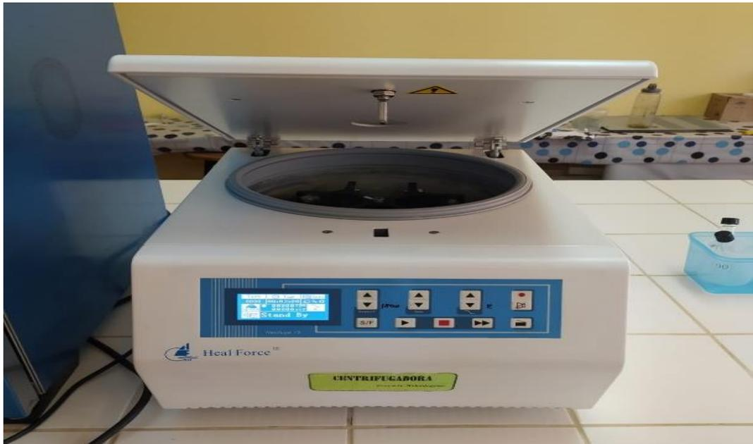
**Figura 29.** Centrifugadora para el proceso de centrifugación de las muestras
