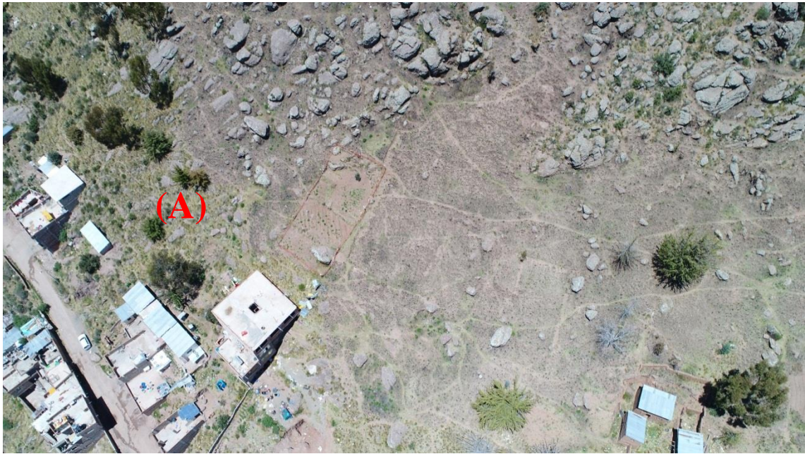
FIGURA N°15: (A) Bloques de rocas expuestas a caídas viviendas en peligro (Barrio Miraflores).
