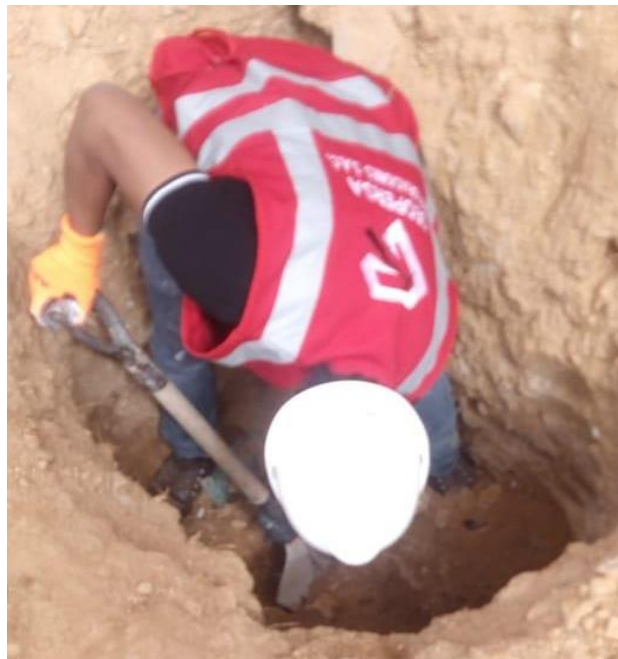
FIGURA N°18: Toma de muestra de suelo para ensayos de laboratorio.
