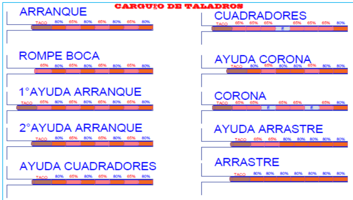
Figura 11. Carguío de taladros propuesto, uso de tacos y espaciadores
