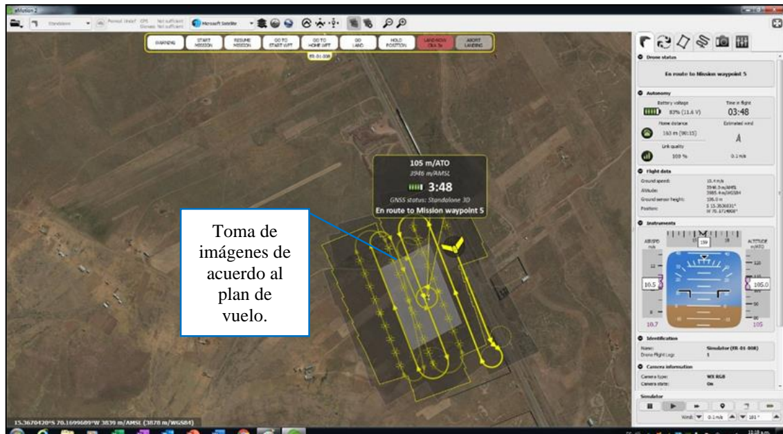
Figura 39. Vista del lanzamiento del RPAS para completar la toma de imágenes con los parámetros establecidos
