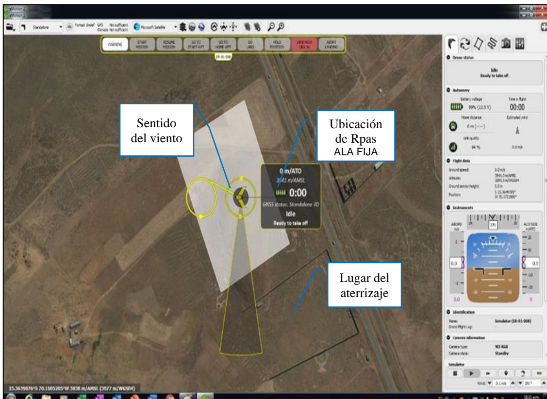
Figura 36. Vista del PLAN DE VUELO en el software eMotion 2 enlazado con el RPAS Ebee Sensefly
