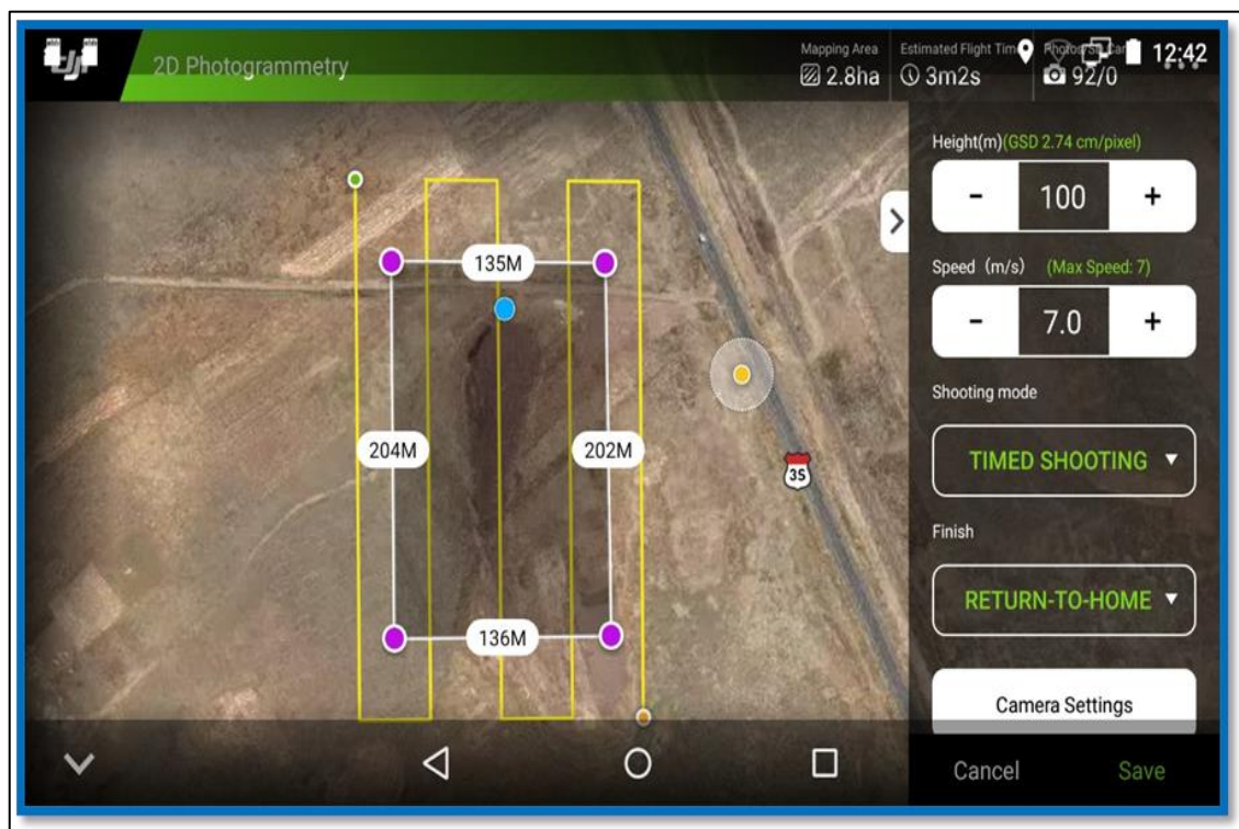
Figura 30. Vista de la Configuración de para la ejecución del vuelo con altura de vuelo 100m, GSD 2.74 cm/píxel y velocidad del vuelo 7 m/s
