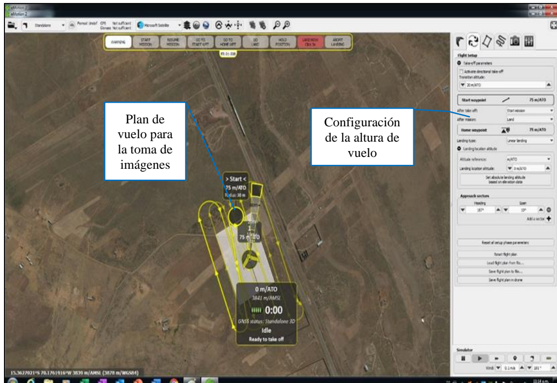
Figura 37. Vista de la configuración de los parámetros de vuelo
