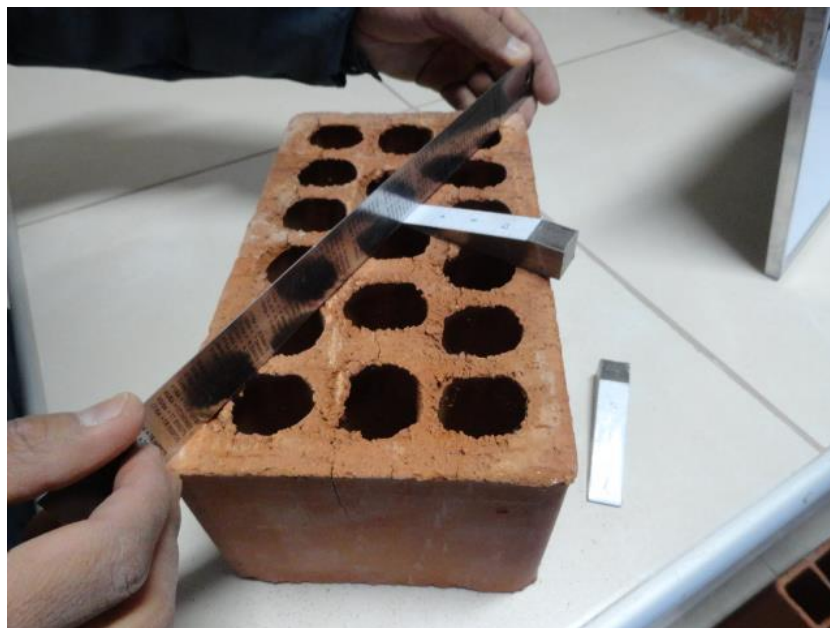
Figura 16: Acercamiento a la medición del alabeo
