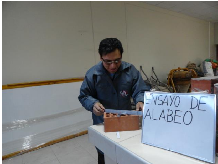
Figura 15: Medición de la concavidad del ladrillo king kong mecanizado.
