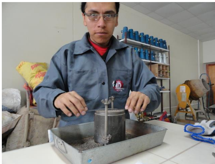
Figura 22: Enrasado de la arena dentro del molde.
