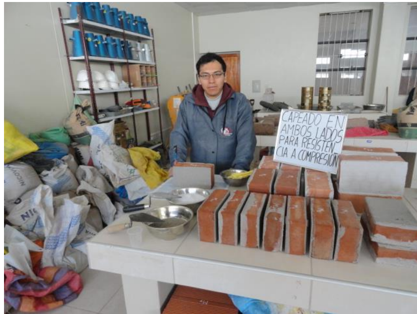
Figura 25: Refrentado de los ladrillos king kong artesanal y mecanizado.
