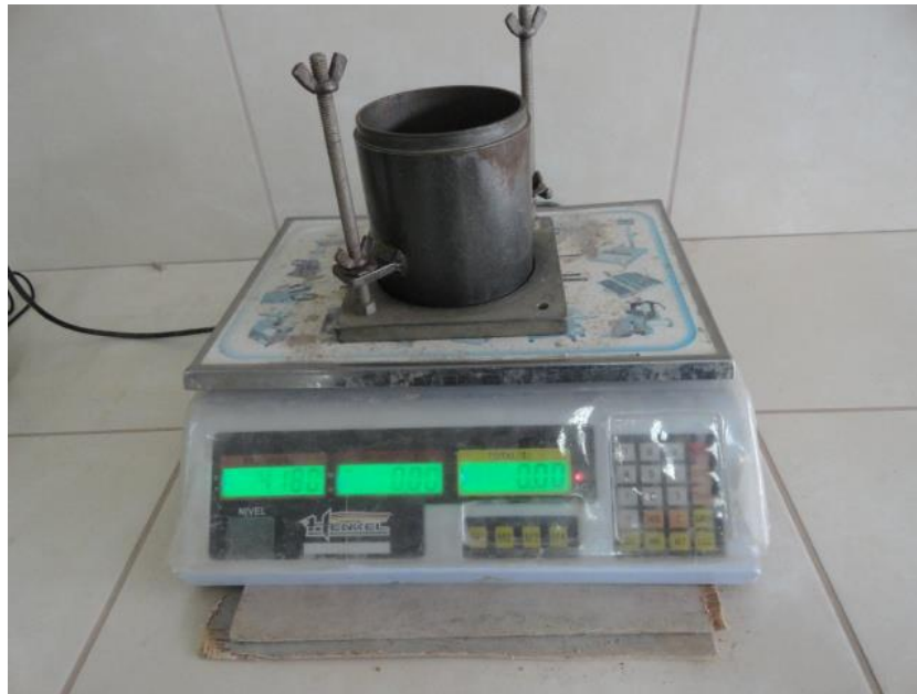
Figura 21: Determinación del peso del molde para determinar el peso de la arena.
