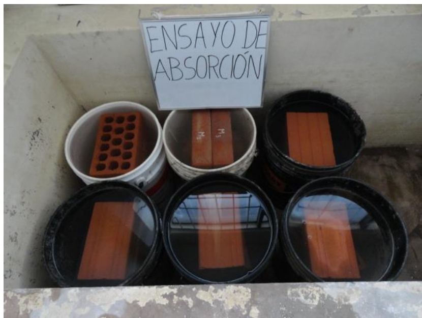
Figura 18: Saturación de los especímenes por 24 horas.
