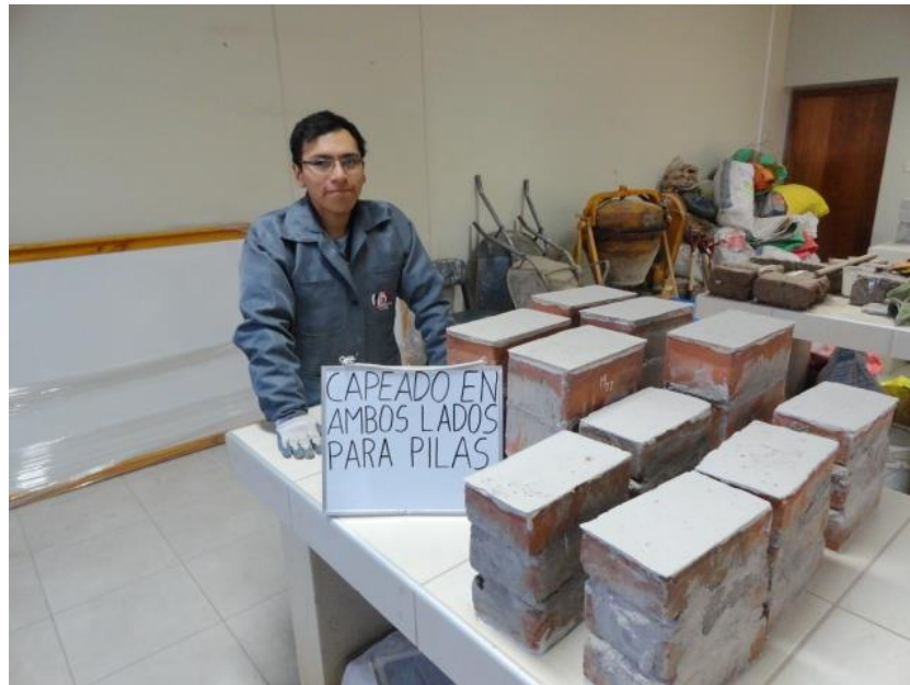
Figura 27: Refrentado de los prismas de albañilería
