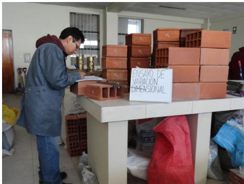
Figura 14: Mediciones de los ladrillos para techo artesanal, semimecanizado y mecanizado con vernier para hallar la variación dimensional.
