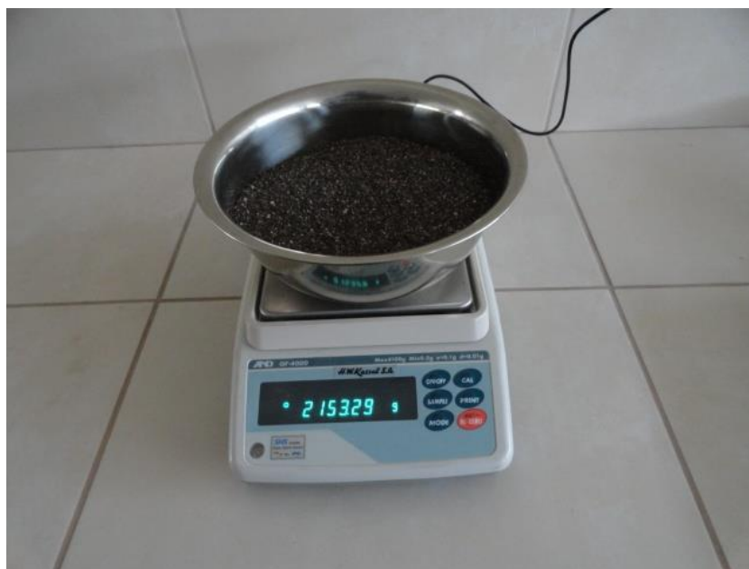
Figura 24: Pesado de la arena que estaba dentro de los vacíos del ladrillo.
