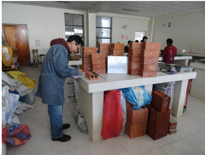
Figura 13: Mediciones de los ladrillos pandereta artesanal, semimecanizado y mecanizado con vernier para hallar la variación dimensional.
