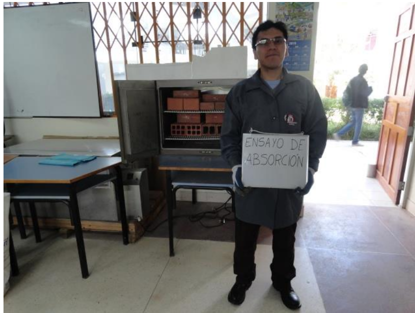
Figura 17: Secado de los especímenes en el horno a 110°C por 24 horas.
