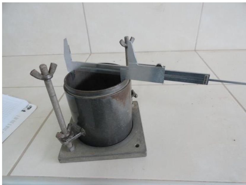
Figura 20: Medición del diámetro del molde para hallar el peso específico de la arena.
