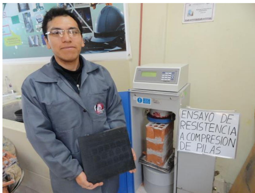
Figura 28: Preparación de la resistencia a compresión del prisma de albañilería para los ladrillos king kong mecanizados
