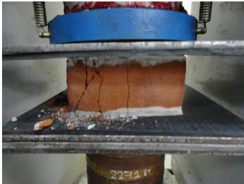
Figura 26: Rotura del ladrillo king kong artesanal.
