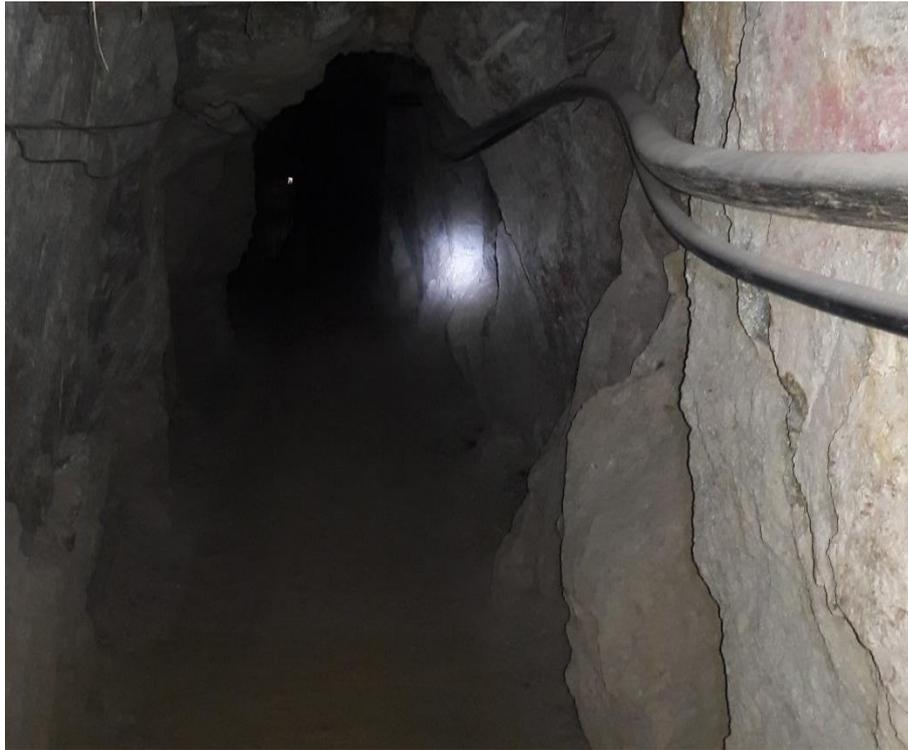
*Figura N° 10: Ventilación tercera línea Galería 819E*
