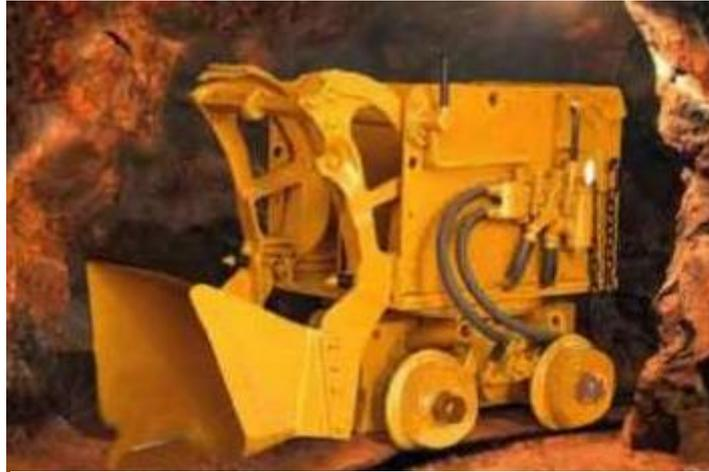
***Figura N° 6: Pala neumática EIMCO 12B***
