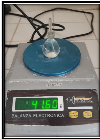
Figura 24: Picnómetro con agua destilada
