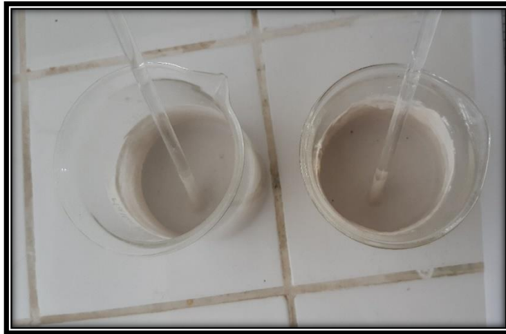
Figura 15: Homogenización óptima granulometría 80 y 200
