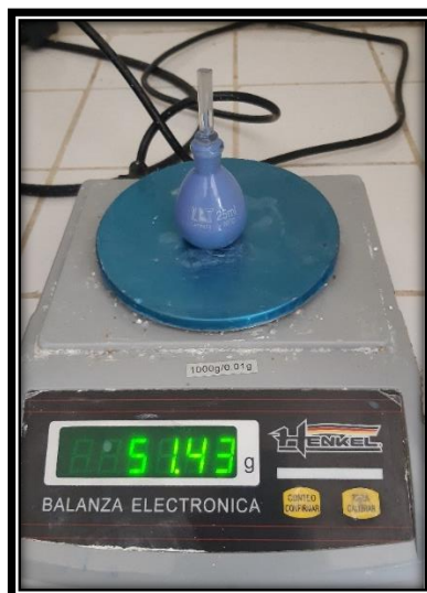
Figura 25: Picnómetro con muestra
