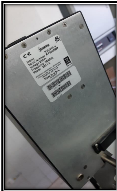
Figura 23: Características y modelo del viscosímetro.
