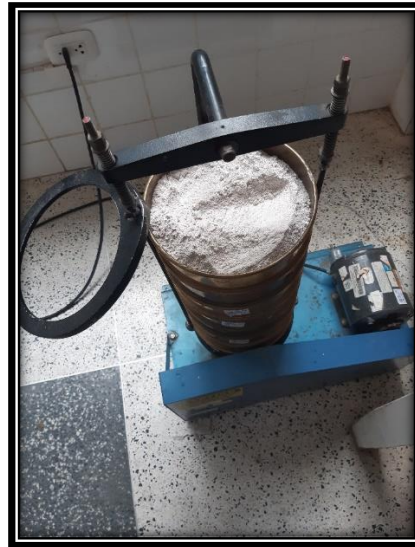
Figura 6: Tamiz con materia prima \text{CaCO}_3
