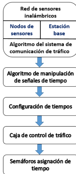
Figura 2.9: Funcionamiento del semáforo inteligente usando redes de sensores inalámbricos
