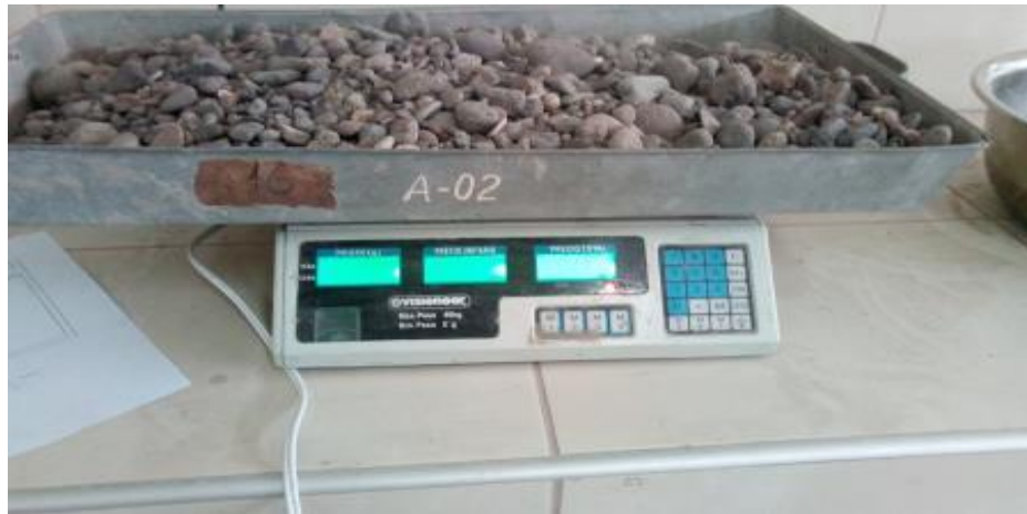
Figura 3.3: Pesaje del Agregado Grueso Secado al Horno
