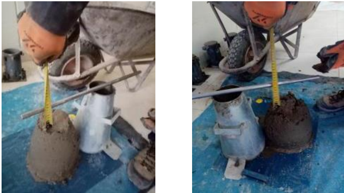
Figura 3.11: Medición del Slump del Concreto Fresco
