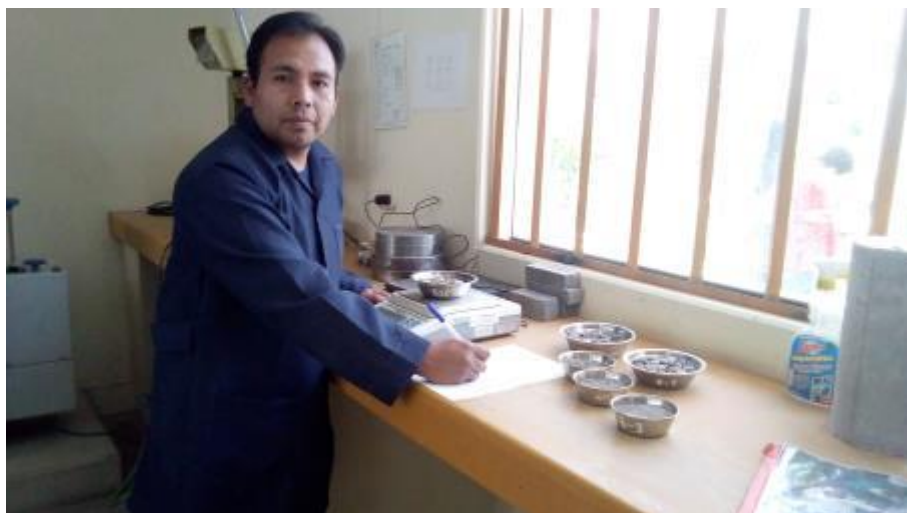
Figura 3.5: Pesaje de Material Seleccionado por Tamices
