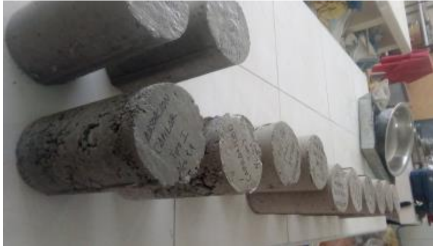
Figura 4.9 Probetas elaboradas para Determinar la Velocidad de Absorción por Capilaridad
