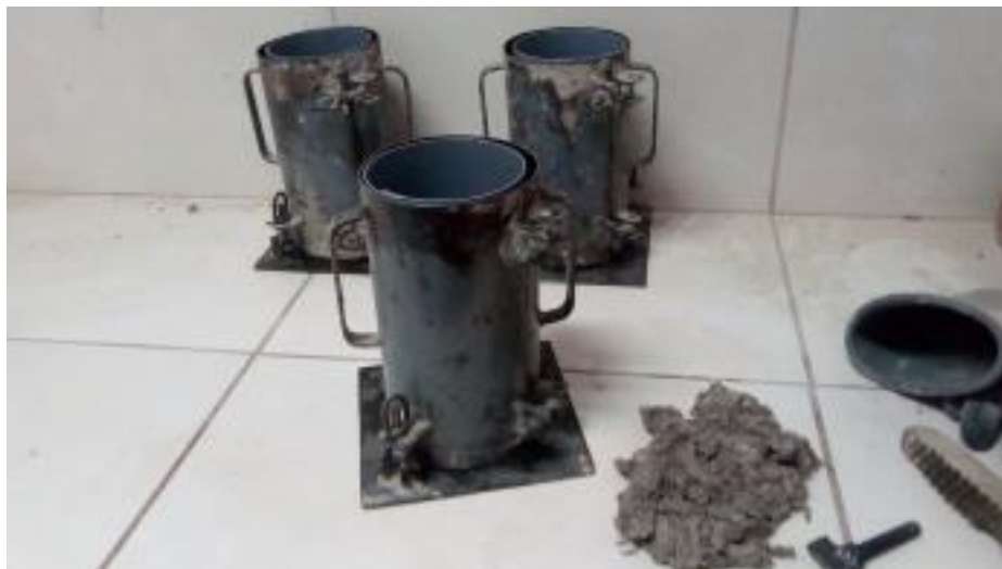
Figura 3.12: Limpieza y Preparación de Moldes Cilíndricos
