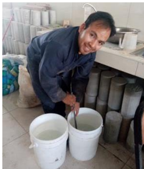
Figura 3.16: Mezcla del Sulfato de Magnesio y Cloruro de Sodio con el Agua de Curado
