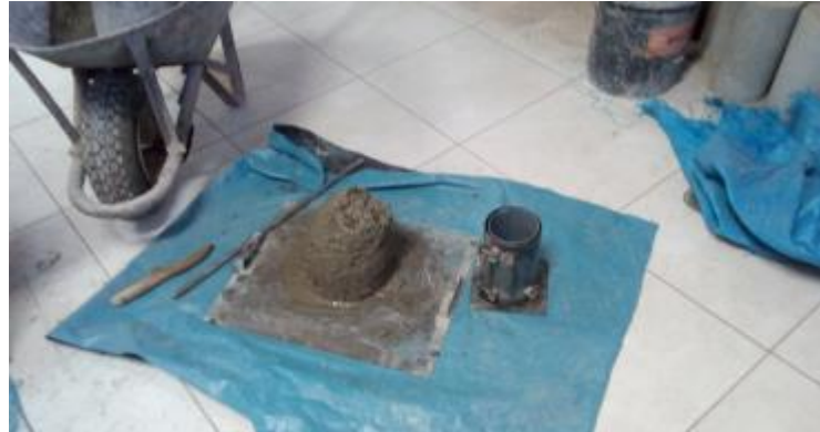
Figura 3.9: Determinación del Slump del Concreto Fresco con Cemento Tipo I
