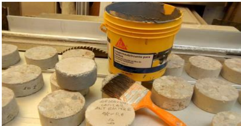
Figura 3.25: Sellado de Superficies Laterales de Especímenes.
