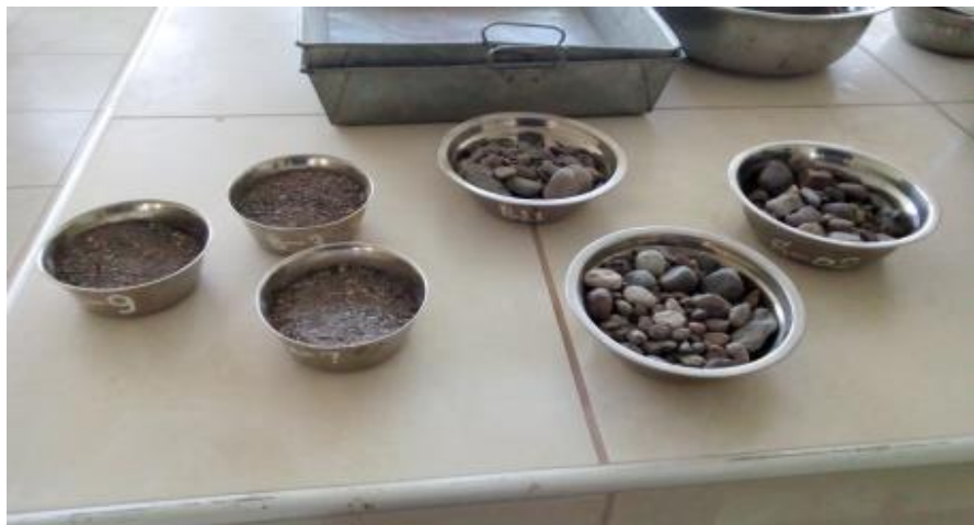
Figura 3.4: Material Seleccionado por Tamices para su Pesado
