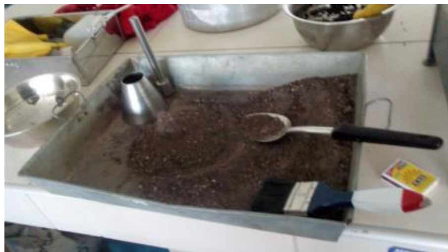
Figura 3.1: Procedimiento para Determinar la Absorción en Agregado Fino
