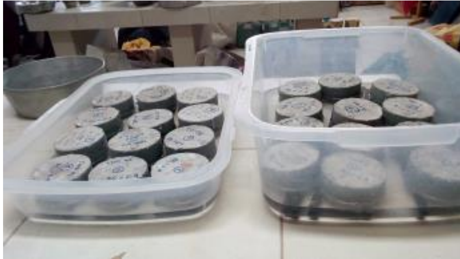
Figura 4.10 Ensayo para Determinar la Velocidad de Absorción por Capilaridad Fuente: Elaborado por el equipo de trabajo
