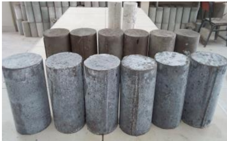
Figura 3.19: Probetas Listas para Ser Sometidas al Ensayo de Compresión Simple
