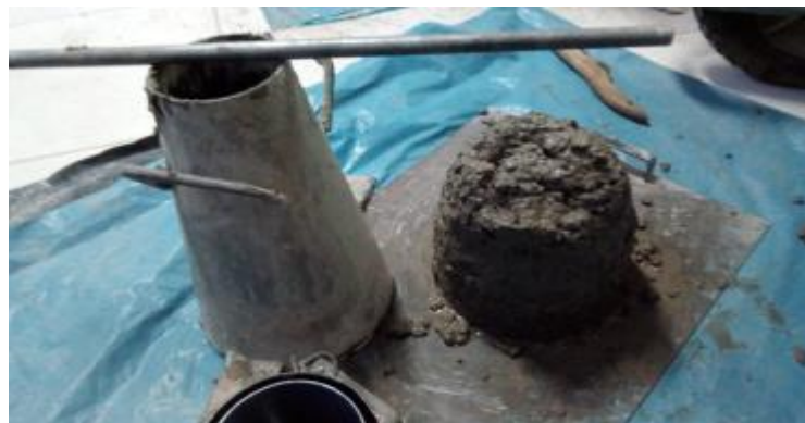
Figura 3.10: Determinación del Slump del Concreto Fresco con Cemento Tipo HS
