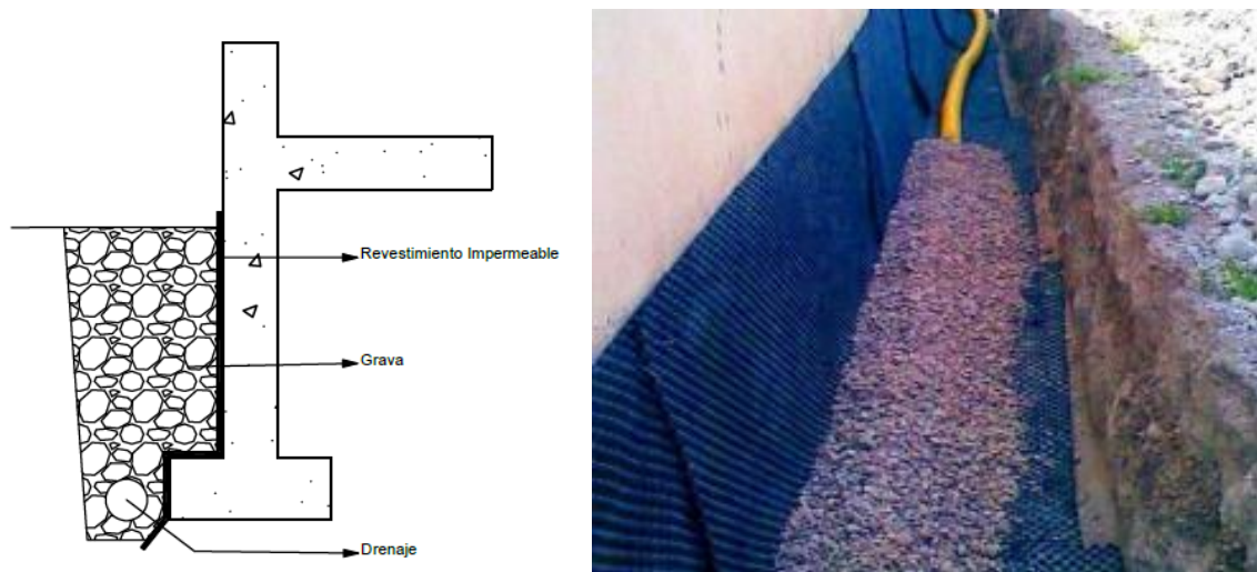
Figura 2.7: Drenaje y Revestimiento Impermeable
