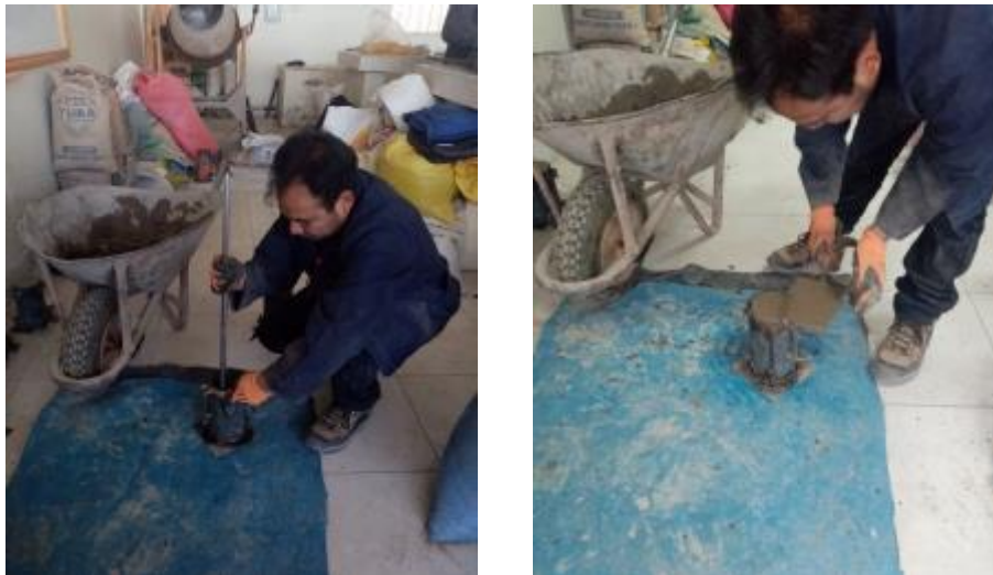
Figura 3.14: Elaboración de Probetas de Concreto
