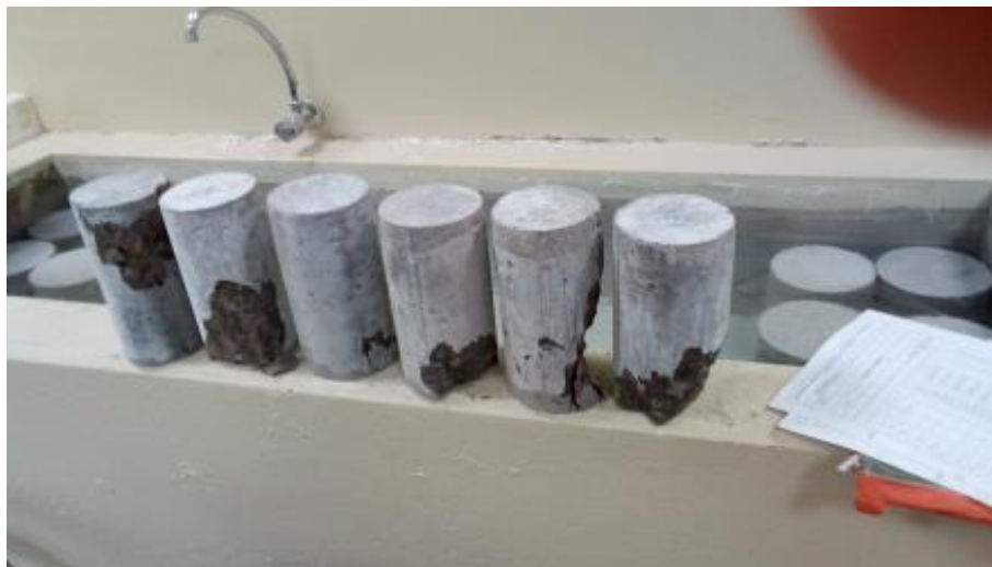
Figura 3.21: Probetas Curadas en Solución con Sulfato de Magnesio Sometidas a Compresión Simple
