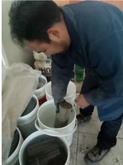
Figura 3.17: La Exposición de las Probetas de Concreto a la Solución de Curado Fuente: Elaborado por el equipo de trabajo.
