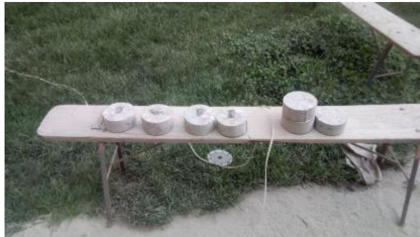
Figura 4.7 Preparación de Muestras para Determinar la Velocidad de Absorción por Capilaridad
