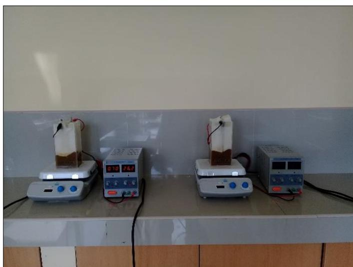
*Figura 32.* Celdas electrolíticas durante el tratamiento de las aguas residuales
