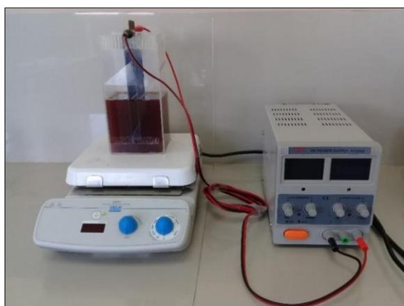
Figura 14. Reactor electrolítico para el tratamiento de aguas residuales rojas por el método de electro-Fenton
