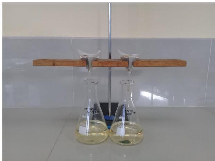
*Figura 33.* Filtración de las muestras después del tratamiento por electro-Fenton
