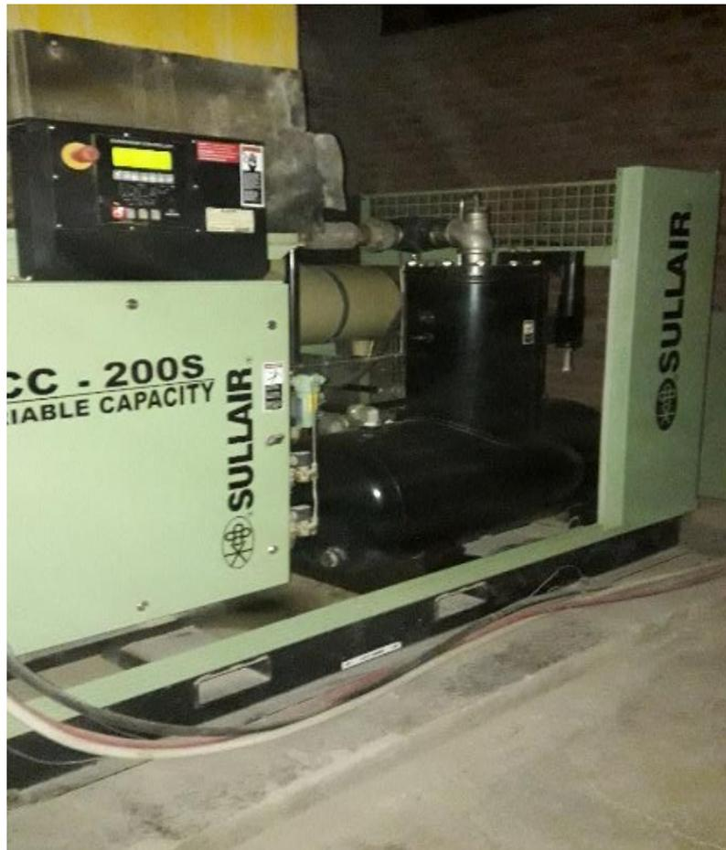
Figura 19: Compresora Electrica Sullair -200S
