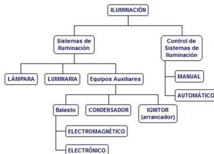
Figura N° 10: Componentes de la tecnología de iluminación
