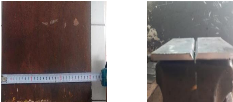
Figura 12. Ranura tipo V con un ángulo de 60° y separación de 2mm
