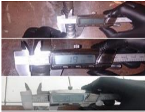
Medición de ancho de cordón de soldadura
