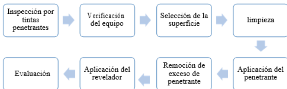
Figura 5. Secuencia de un ensayo por líquidos penetrantes
