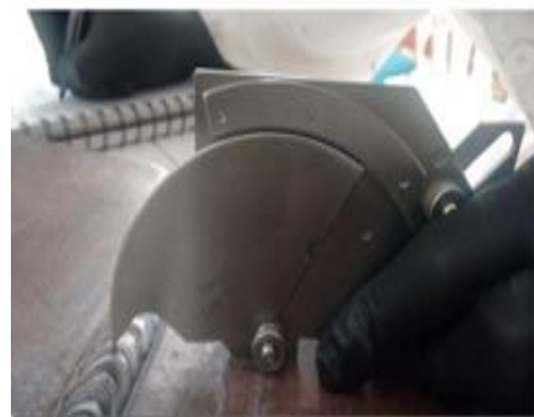
Medición de altura del filete
