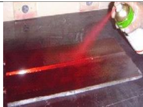
Aplicación del líquido penetrante
