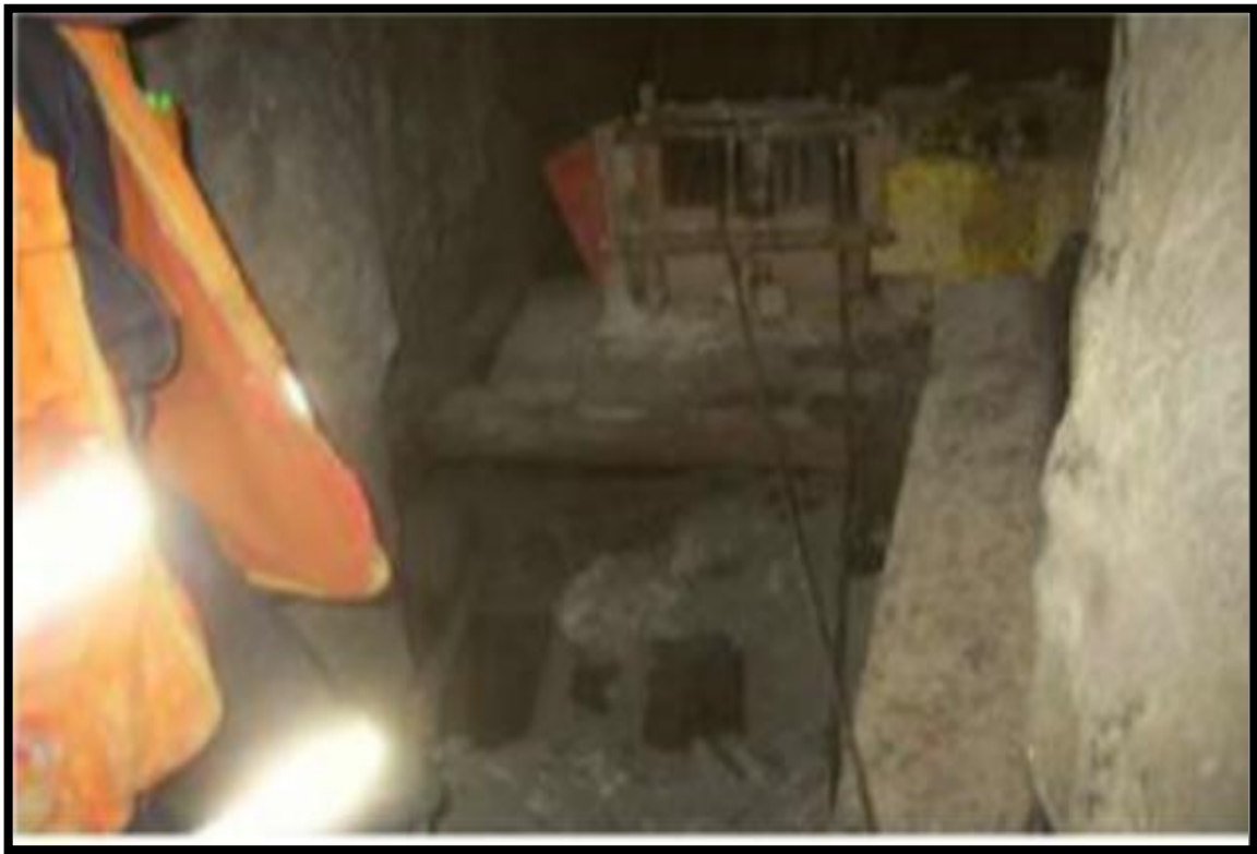
Figura 9: Limpieza de mineral con winche eléctrico. Fuente: (Escalante, 2017)
