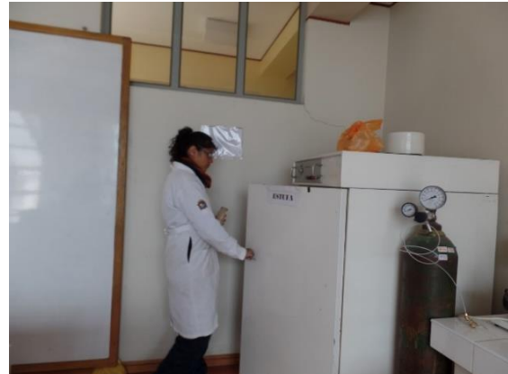
Figura 34. Introduciendo las muestras a la estufa a 60 °C por 24 horas
