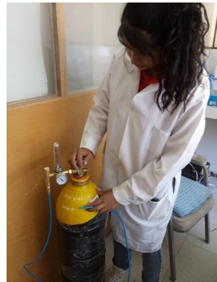
Figura 14. Inicio de la calibración del tanque de nitrógeno UHT (99.999 N)
