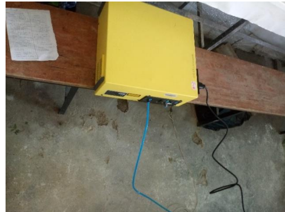
Figura 18. El equipo Gasmeter DX-403, para la medición de metano entérico
