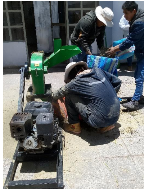
Figura 4. Molino picador forrajero marca Trapp, modelo TRF – 800
