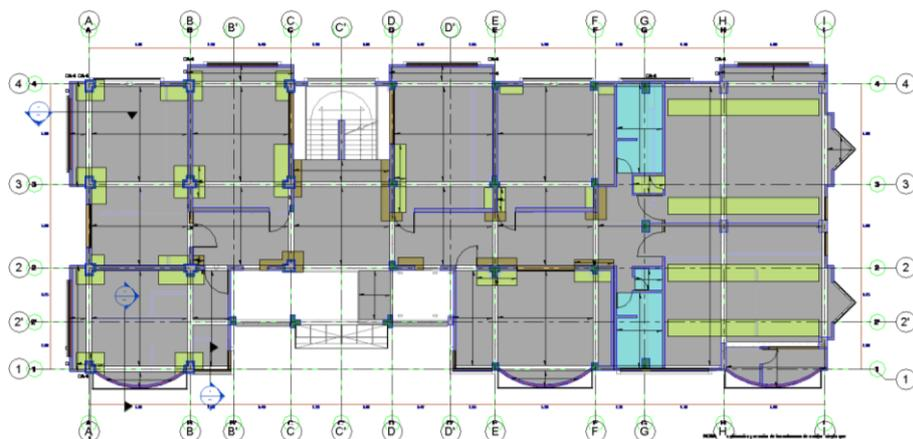
Nota: En la figura 42 se muestra elementos modelados en el programa Revit correspondientes al Segundo nivel. El color gris corresponde al piso terrazo pulido, verde a piso vinílico y turquesa al piso Cerámico. “Elaborado por el equipo de trabajo”.
