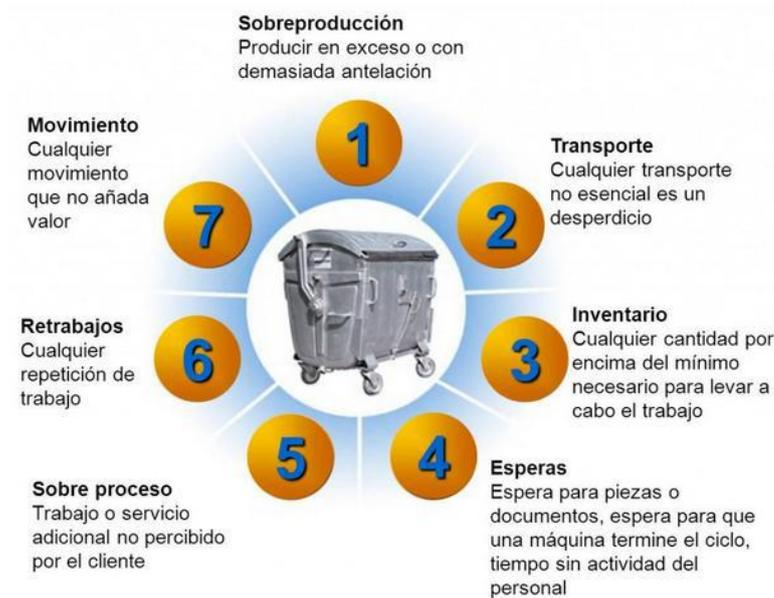
Nota: La figura 25 muestra los desperdicios agrupados en 7 tipos: Sobreproducción, Transporte, Inventario, Esperas, Sobre procesos, Retrabajos y Movimiento. (Müller, 1988)
