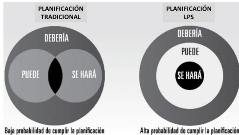
Nota: La figura 26 muestra dos conjuntos, en la primera se observa un área pequeña de intersección entre lo que “debería”, “puede” y “se hará” en la Planificación Tradicional, mientras que el segundo el área de “se hará” está garantizado por lo que “se puede” y “debería” hacerse, logrando así una alta posibilidad de cumplir la planificación LPS. (Vargas, 2019)
