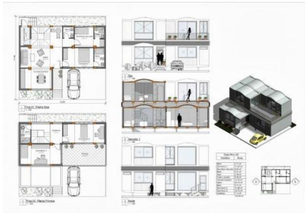
Nota: Esta figura 15 muestra la integridad de un modelo BIM en los planos 2D. (Usaquén, 2019)
