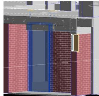
Cuadro de vanos en el que especifica la altura de las puertas sin considerar el nuevo NPT. +0.25      Modelo BIM 3D: Puerta que sobrepasa la viga existente
