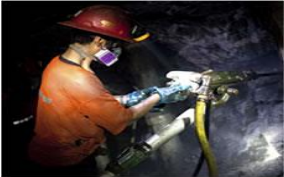
Figura 3. Maestro perforista operando una maquina Jackleg en un frente del Nv. 2270.
