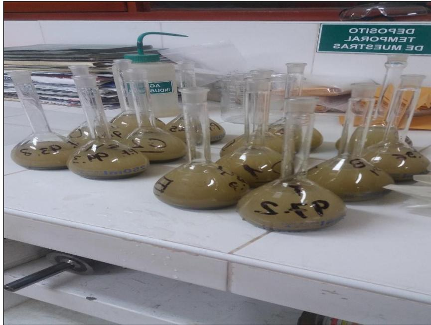
**Figura 33.** Determinación de gravedad específica realizada a las muestras de muestreo general
