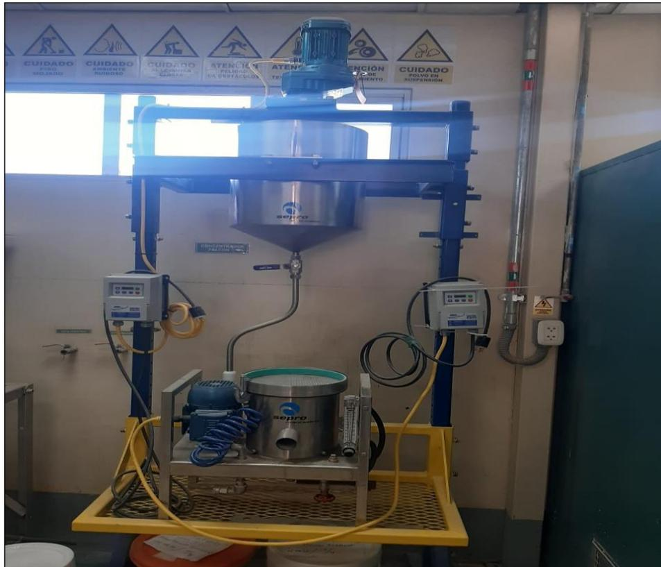
**Figura 43.** Deslamador Concentrador falcón a nivel laboratorio
