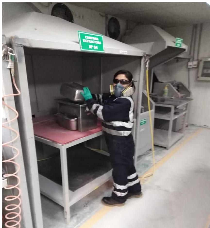
**Figura 38.** Se inicia con el cuarteo de las muestras para poder homogenizar
