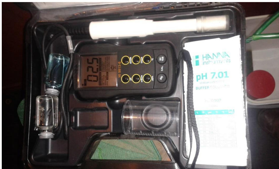
Figura 6 Equipo multiparámetro para el registro de los parámetros físico químicos, en el cultivo de pejerrey Odonthestes bonaerensis , Puno, agosto 2018 a enero del 2019.
