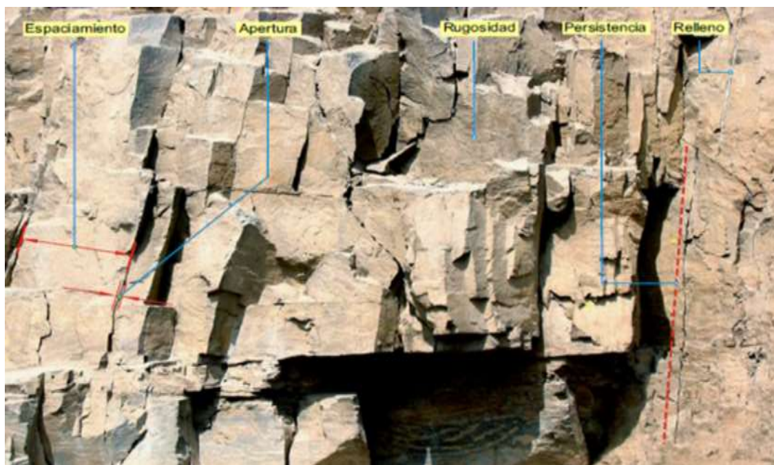
Figura 1. Descripción de las condiciones de las discontinuidades
