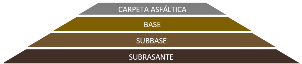
Figura 1. Estructura del Pavimento flexible
