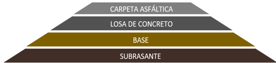
Figura 3. Estructura del Pavimento mixto
