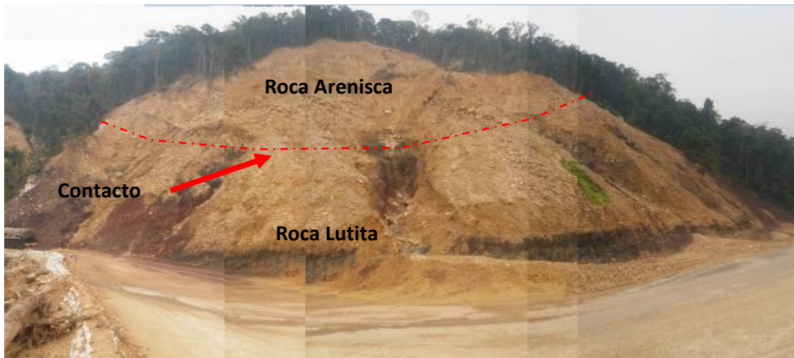
Figura N° 15: Grupo Huayabamba, sub km 344+000 al km 344+540, areniscas feldespáticas cuarzosas marrón claras, suprayacente a lutitas rojas a marrón. (Operadora SurPeru).
