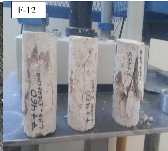
Figura M-12. Rotura a compresión simple de núcleos, km 7+460
