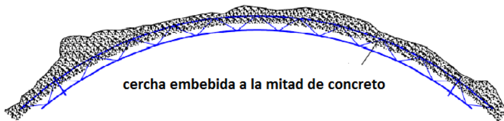
Figura 36. Gunitado de Shotcrete, (Hjálmarsson, 2011) Fuente: Elaboración del Autor
