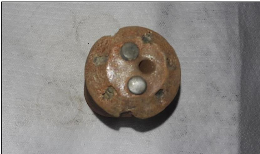
Figura N.º58: *Broca de 45 mm – R32 con daños en los botones periféricos*
