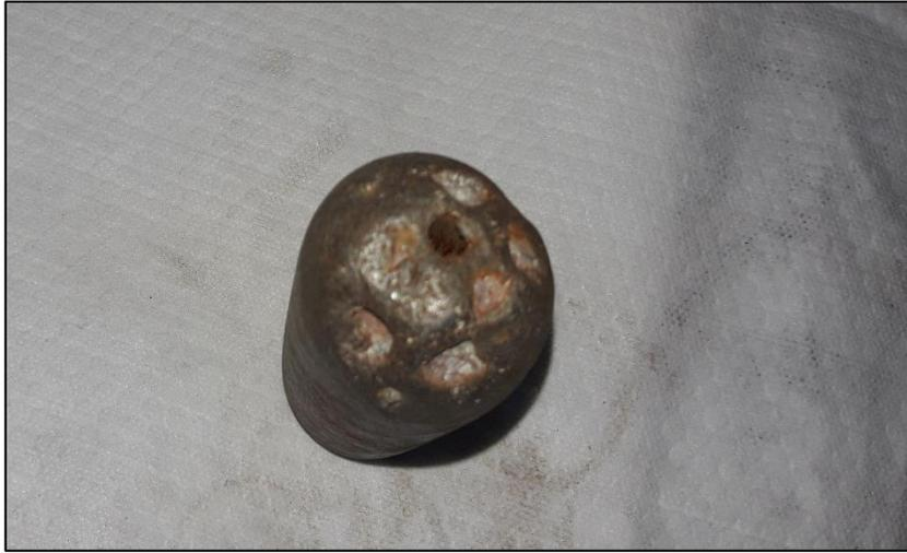
Figura N.º57: *Broca de 45 mm – R32 con perdida completa de los botones*
