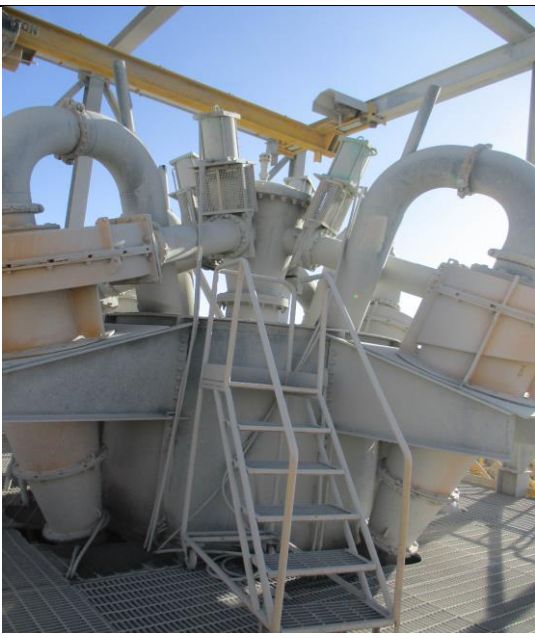
E4: Ciclón D-26 del molino.
