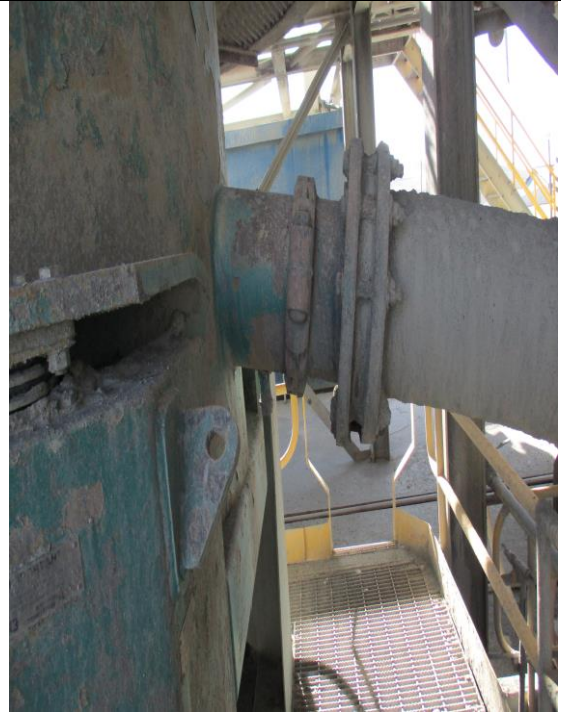
E14: Descarga de relave del concentrador.
