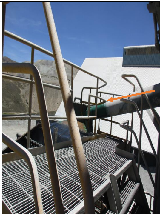
E7: Alimentación del ciclón a la zaranda.
