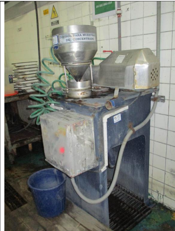
E26: Divisor de pulpa para el concentrado.
