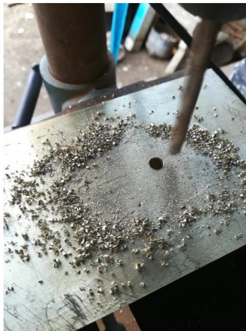
Figura 66. Perforando para perno de anclaje \frac{1}{8} .
