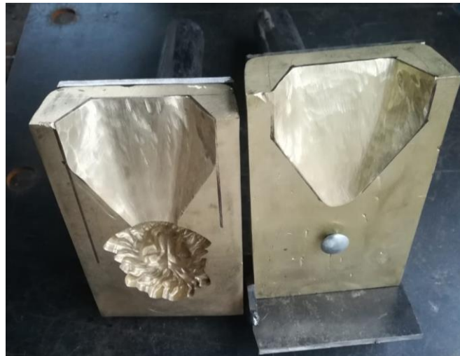
Figura 27. Riser mecanizado y perno anclaje.
