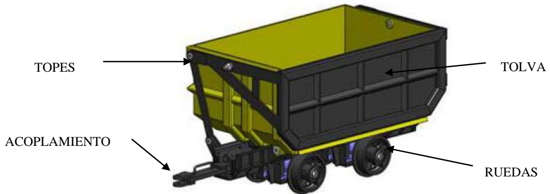
Figura 36: Partes principales de carros mineros
