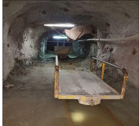
Plataforma para traslado de materiales
