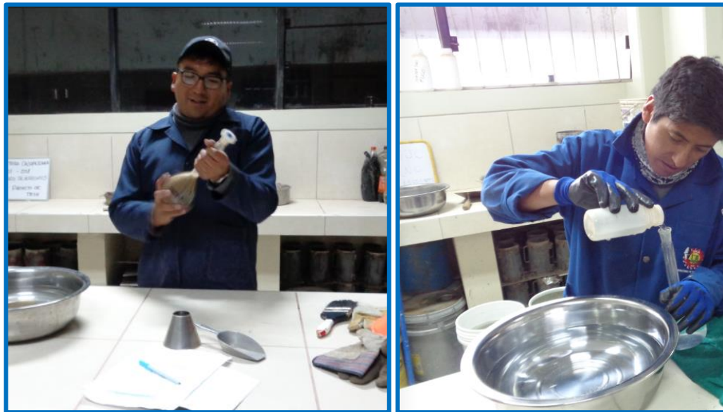
Figura 21: Llenado de agua, agregado fino al picnómetro y girado para eliminar aire atrapado.
