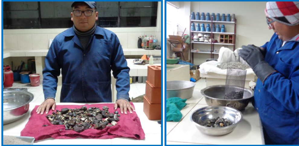
Figura 22: Secado del agregado grueso hasta un estado S.S.S y pesado con la canastilla sumergida
