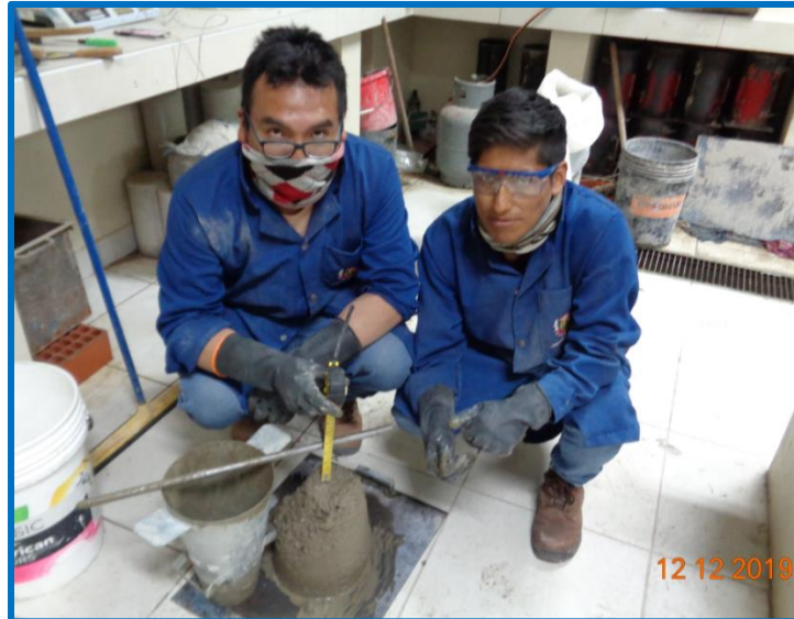
Figura 42: Asentamiento del concreto Fuente: Elaborado por el equipo de trabajo.
