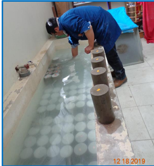
Figura 41: Curado de probetas de concreto Fuente: Elaborado por el equipo de trabajo
