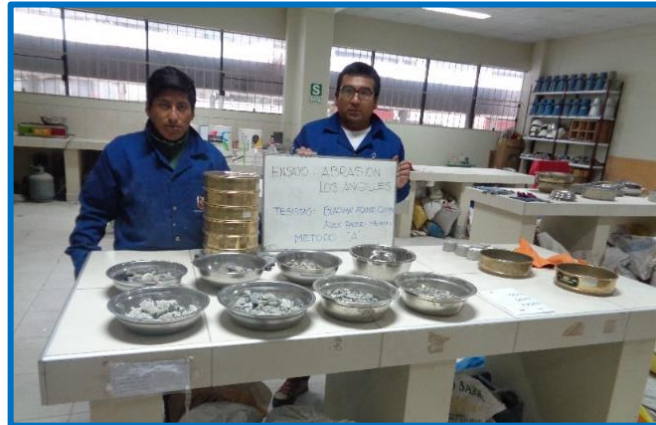
Figura 33: Agregados retenidos en los tamices para ensayo de desgaste Fuente: Elaborado por el equipo de trabajo.
