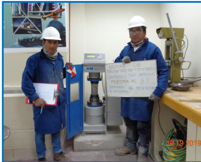
Figura 43: Ensayo a la compresión del concreto Fuente: Elaborado por el equipo de trabajo.
