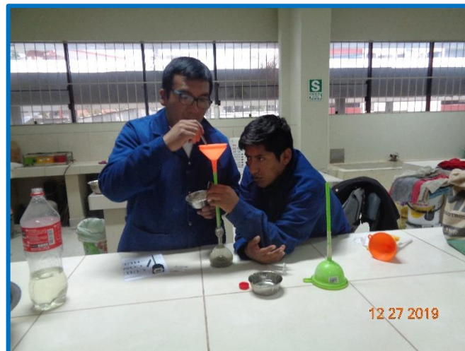
Figura 39: Colocación del cemento en el frasco le chatelier Fuente: Elaborado por el equipo de trabajo.
