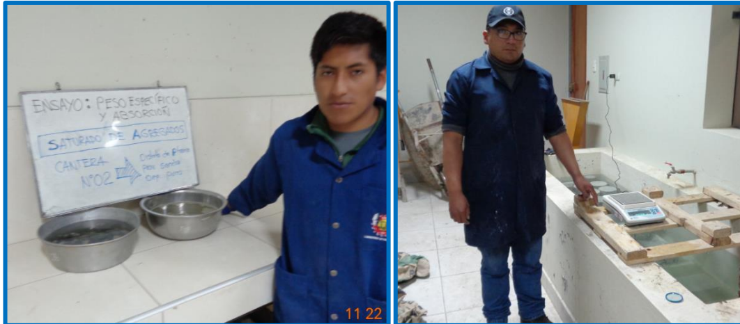
Figura 23: Pesaje con canastilla sumergida del agregado grueso Fuente: Elaborado por el equipo de trabajo.
