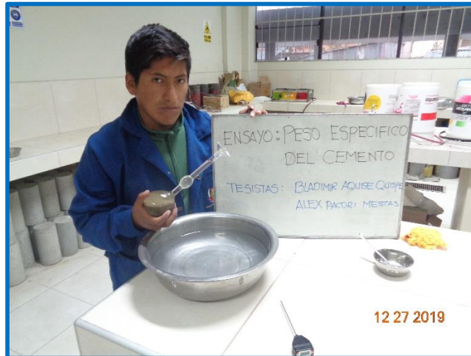
Figura 38: Agitado de frasco le chatelier para eliminar burbujas de aire Fuente: Elaborado por el equipo de trabajo.
