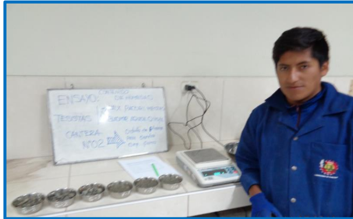
Figura 19: Contenido de Humedad - Agregado Grueso y Agregado Fino.
