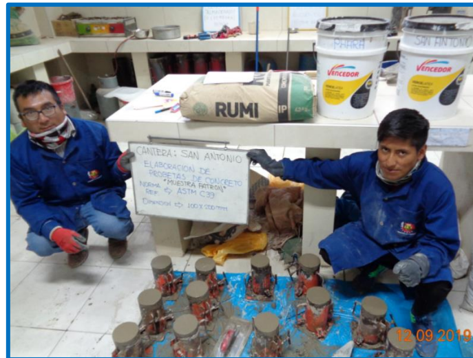
Figura 40: Elaboración de probetas de concreto Fuente: Elaborado por el equipo de trabajo.
