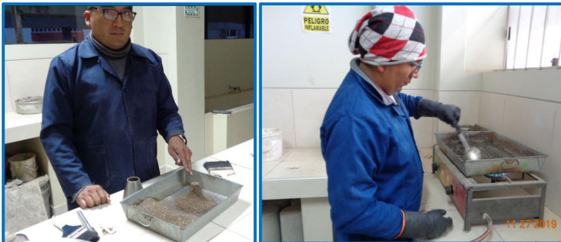
Figura 20: El agregado fino secada en una estufa hasta la condición SSS y se coloca en un cono hasta que se desmorone al retirar el cono.
