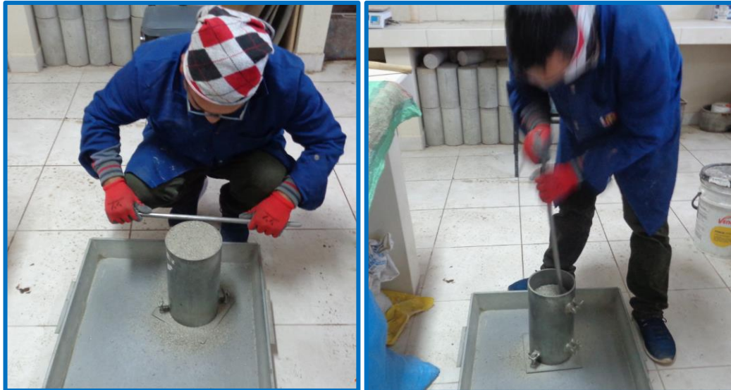
Figura 25: Procedimiento para determinar peso unitario suelto y compacto del agregado fino.
