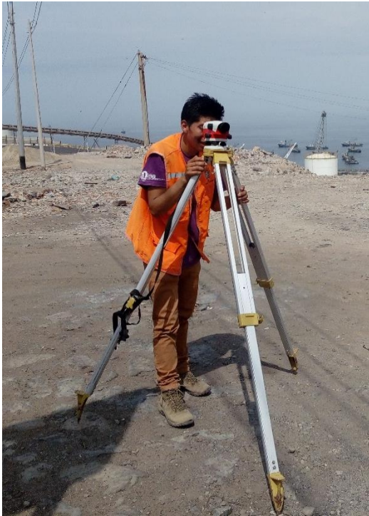
Foto 05: Realizando Nivelación Geométrica Tramo Matarani – Mejia
