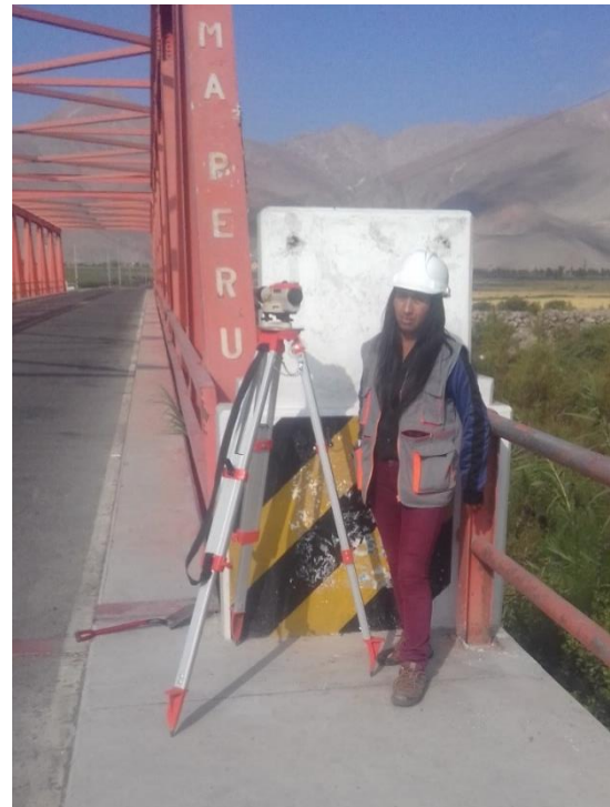
Foto 06: Recolección de datos Nivelación Geométrica Tramo Mejia – La curva
