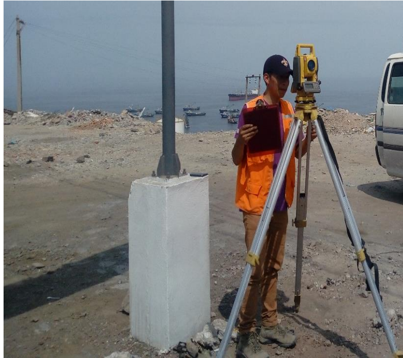
Foto 09: Toma de datos con estacion estacion total, de esta manera se realiza en los dos tramos correspondientes
