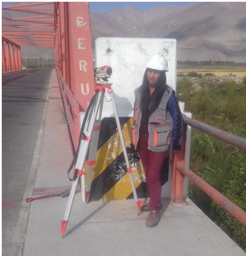
Figura 14. Montaje De Instrumento Nivel De Ingeniero.
