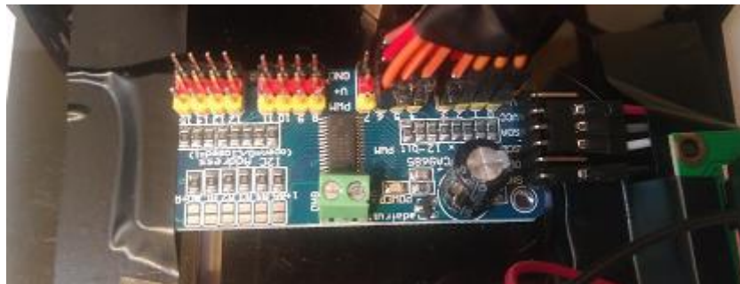
Figura 3.18: Conexión de 7 servomotores a PCA9685
