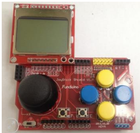
Figura C.8: Joystick Funduino y LCD 5110
