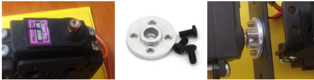
Figura 3.15: Servomotor y disco de acople
