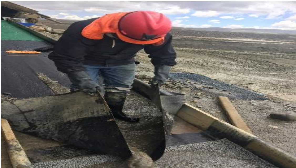
Figura 8. Extracción del concentrado de oro
