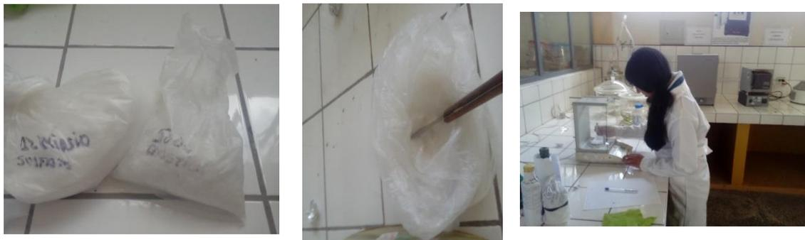
Pesado de la dosis de coagulante y floculante para posteriormente agregarlos.
