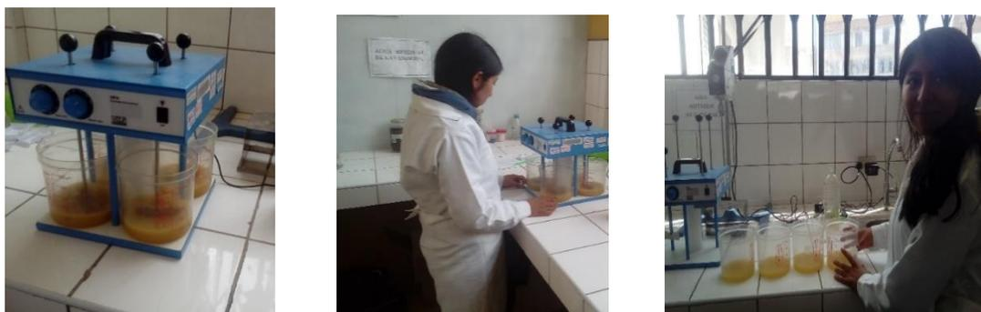
Proceso de coagulación con sulfato de aluminio.
