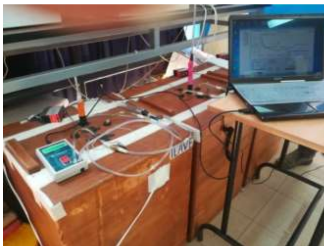
Figura 9. Registro de cantidad de CH 4 y CO 2 en el biogás, laboratorio de Ecología, Universidad Nacional del Altiplano
