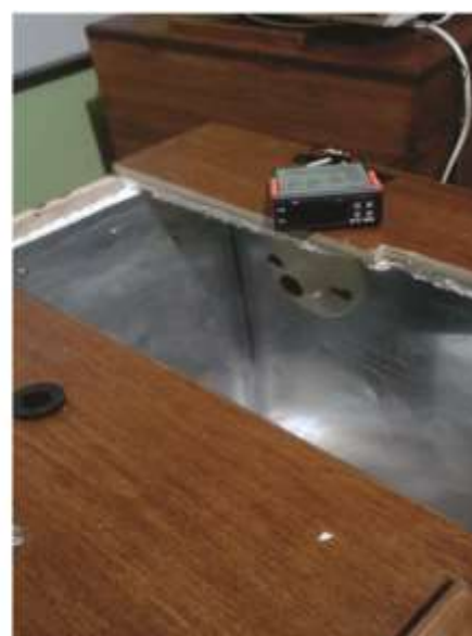
b) Recubrimiento con latón e instalación de soquetes, termostato, tapones para evitar fugas de calor.
