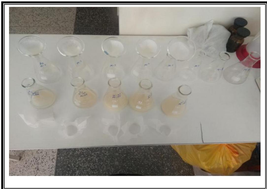
FOTO 09: En la imagen podemos apreciar, decantación de la zeolita para luego ser vertidas en los envases, para el envío de las muestras al laboratorio.
