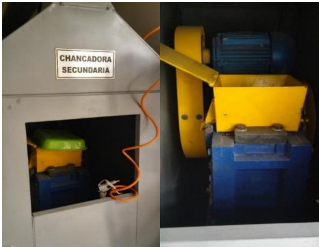
Figura 13. Maquinas que se usaron para el Trituramiento de las muestras. A) Chancadora secundaria Jaw crusher” o trituradora con mandíbulas en el laboratorio de preparación de muestras del INGEMMET. B) Vista detallada de la chancadora secundaria (Fuente: Propia).
