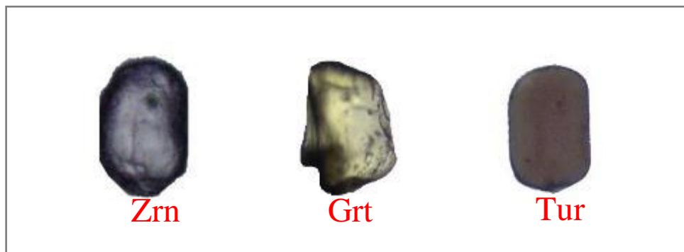
Figura 60. Minerales pesados de areniscas de la Formación Hualhuani parte inferior. Abreviaciones: Zircón (Zrn), Granate (Grt) y Turmalina (Tur). Fuente: Propia.
