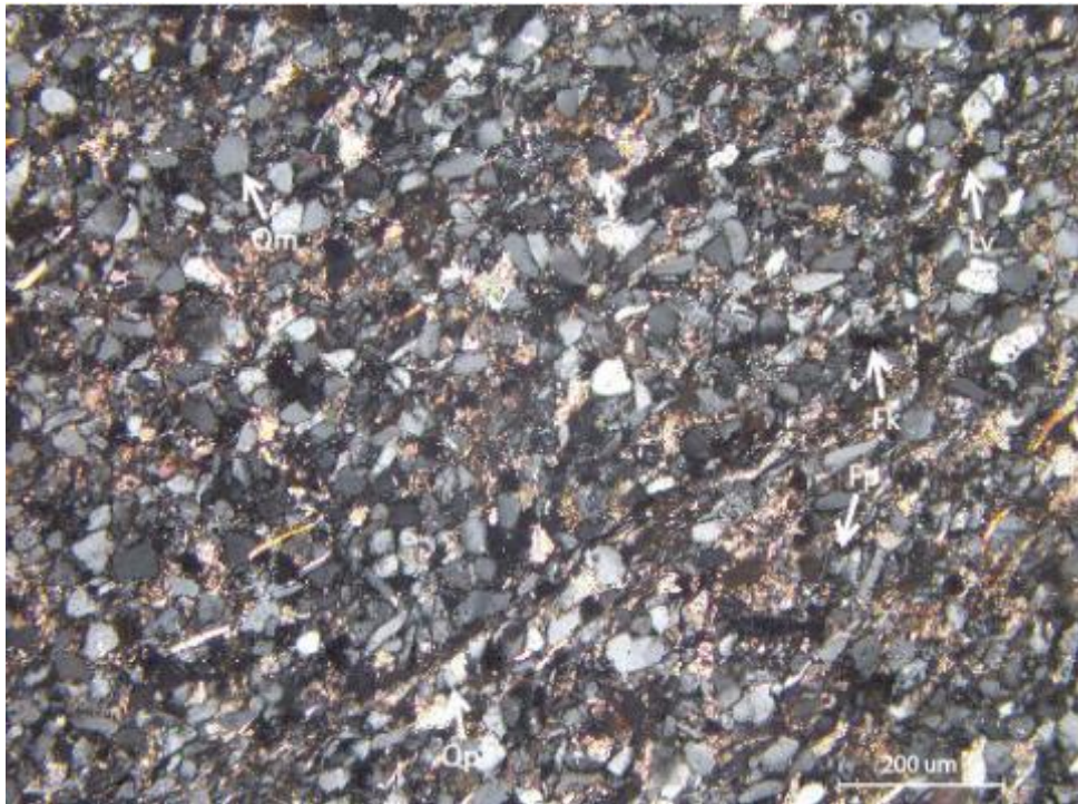
Figura 70. Muestra GR40A-15-035a, (NXs, 10x). Arenisca de grano muy fino que corresponde a la Formación Cachíos parte inferior: Cuarzo monocristalino (Qm), feldespato potásico (Fk), feldespato plagioclasa (Fp) y litoclastos volcánicos (Lv). Fuente: Propia.
