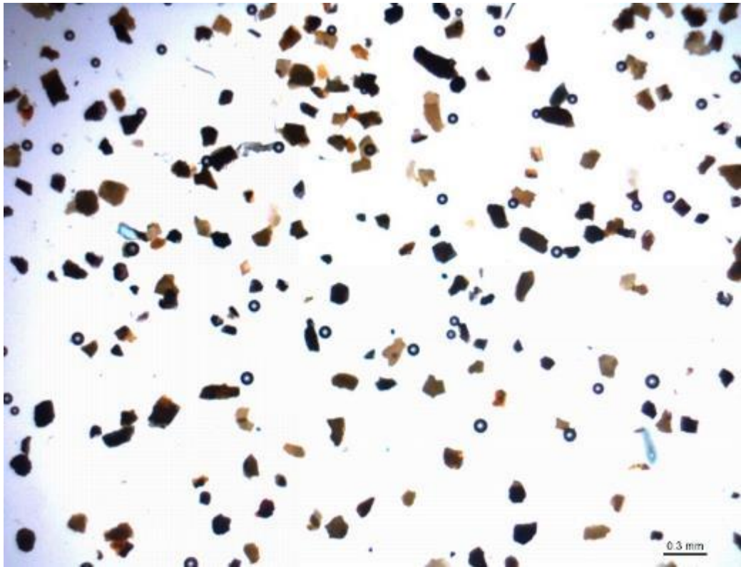
Figura 25. Variedad de minerales pesados después de separar con el líquido pesado. Fuente: Propia.
