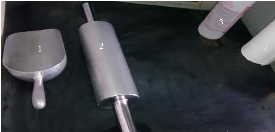
Figura 14. Instrumentos y materiales que se utilizaron para la trituración. 1) Cuchara metálica. 2) Rodillo metálico. 3) Alcohol. 4) Papel toalla. Fuente: Propia.
