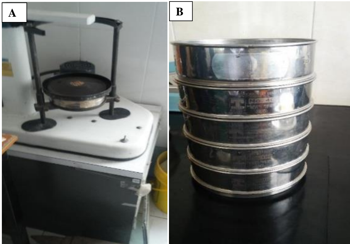
Figura 15. Equipos e instrumentos para proceso de tamizado. A) Maquina vibradora, donde se apilan los tamices y se acelera el proceso de tamizado. B) Tamices de diferentes medidas estándares. Fuente: propia.
