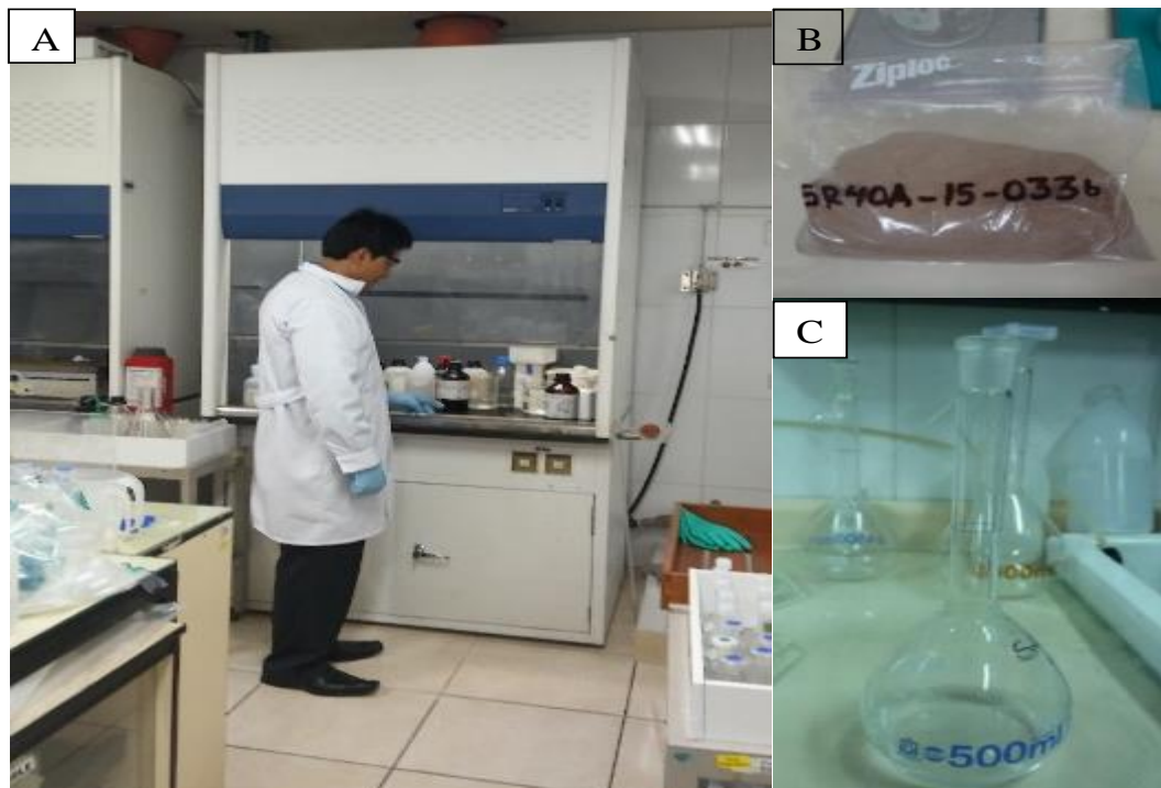
Figura 19. Proceso de baño en ácido acético. A) La fracción de muestra es corroída por el ácido acético en el laboratorio de química del INGEMMET. B) Muestra de la fracción de sedimento que va a trabajarse con el ácido acético. C) Concentrado al 5 % de ácido acético. Fuente: Propia.
