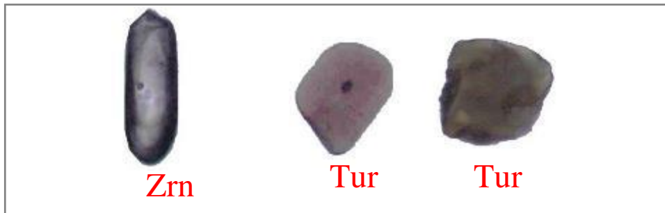
Figura 58. Minerales pesados extraídos de areniscas de la Formación Labra parte inferior. Abreviaciones: Turmalina (Tur) y Zircón (Zrn). Fuente: Propia.
