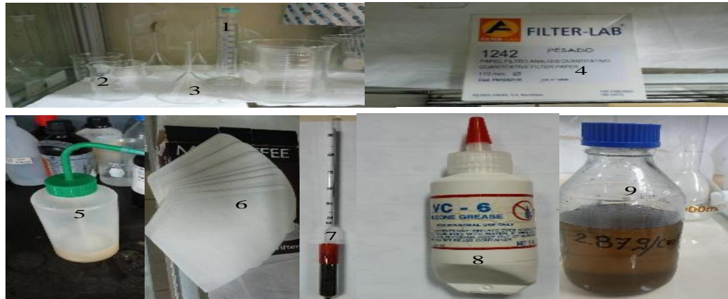
Figura 20. Preparación de instrumentos y materiales para uso de líquido pesado. Se muestra los materiales de laboratorio que se utilizaron para la separación de minerales pesados como: 1) Probeta graduada, 2) Vasos precipitados, 3) Embudos de vidrio, 4) Papel filtro 110 mm de diámetro, 5) Piseta, 6) Filtro para café, 7) Densímetro 8) Silicona y 9) politungstato de sodio (Líquido pesado).
