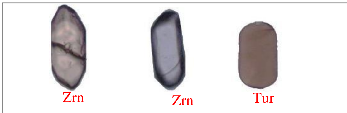
Figura 59. Minerales pesados extraídos de areniscas de la Formación Labra parte superior. Abreviaciones: Zircón (Zrn) y Turmalina (Tur). Fuente: Propia.
