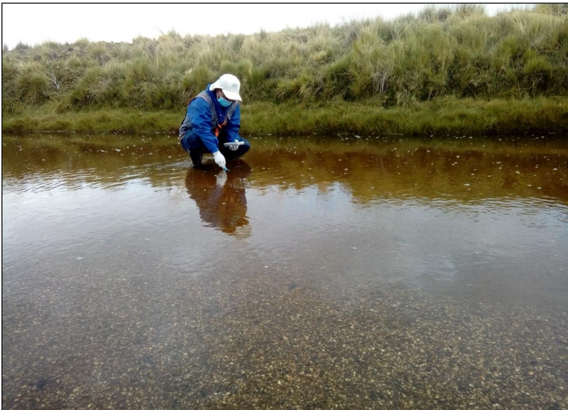
Fotografía 04: Medición de la conductividad eléctrica, temperatura y sólidos totales disueltos
