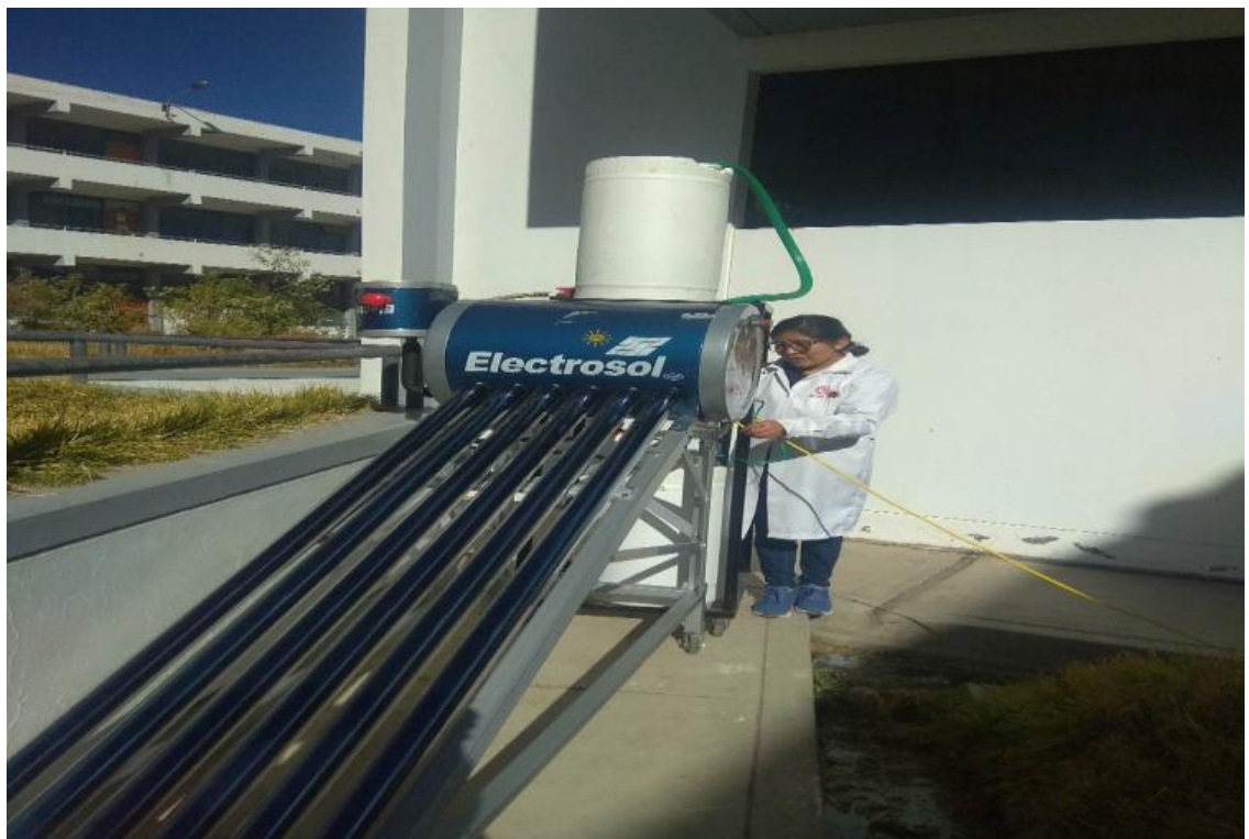
Figura E-2: Ejecución de experimentaciones en equipo de oxidación avanzada.
