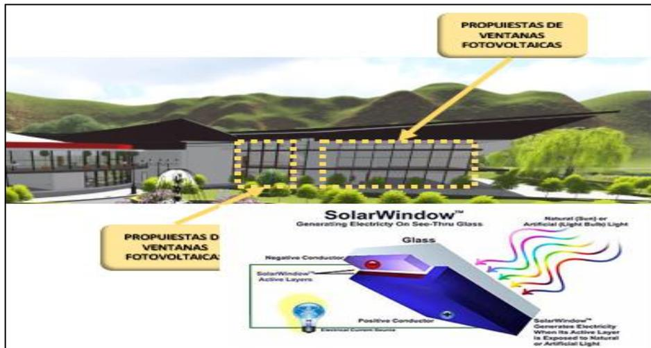
Figura 126 Propuesta de Ventanas Fotovoltaicas
