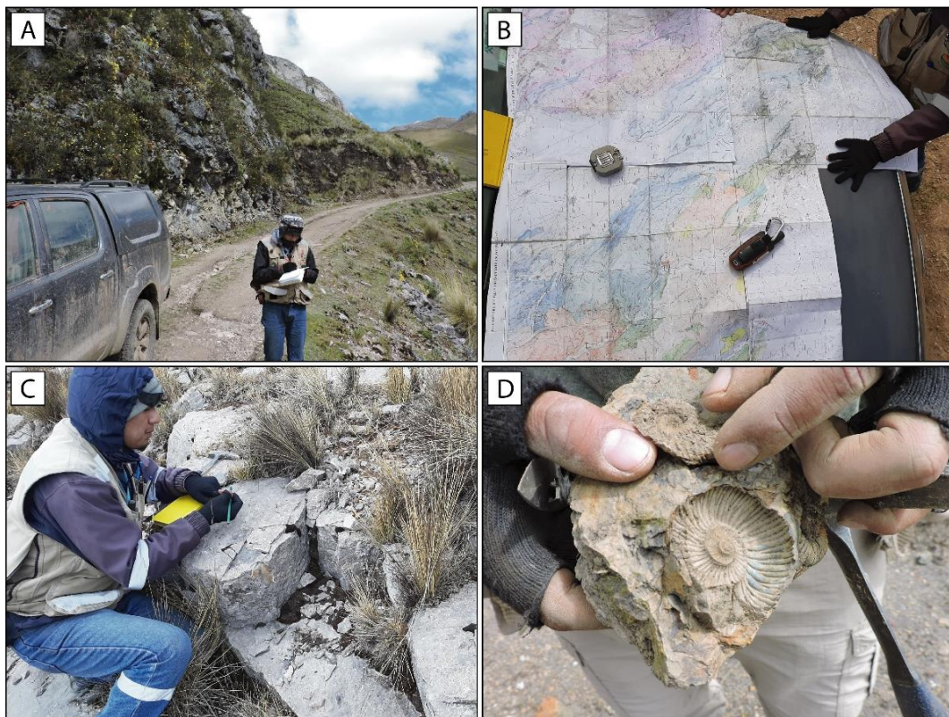
Figura N° 3.3. Cartografiado geológico en campo. En A, registro de la información de campo en la libreta. En B, mapas geológicos de campo a escala 1:50 000 (escala regional). En C, toma de datos estructurales en el afloramiento. En D, colecta de fósiles (ammonites).
