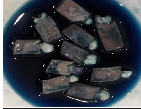
Las piezas fueron sumergidas en Azul de Metileno.
