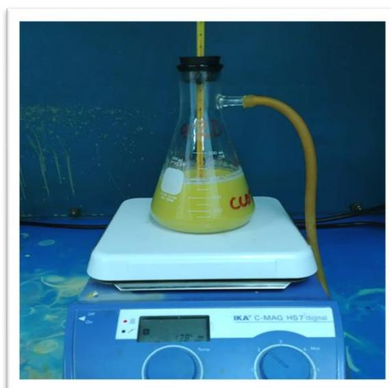
Figura 15. Fotografía de Lixiviación en caliente con HCl durante la experimentación.
