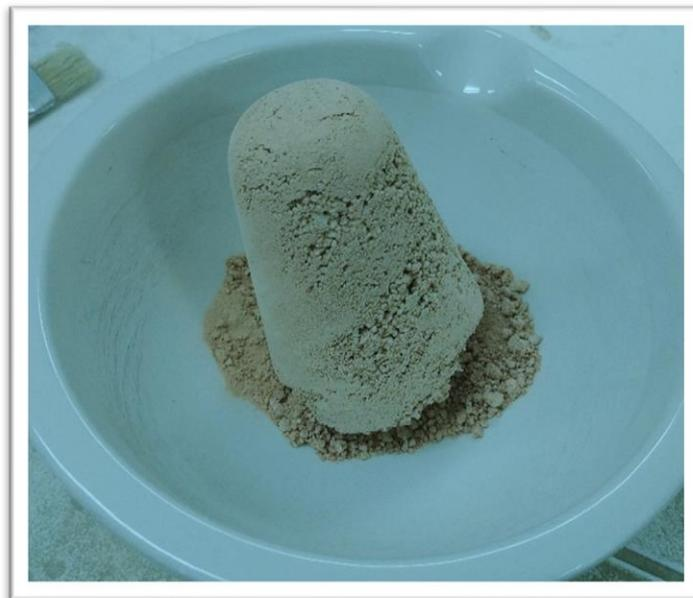
Figura 14. Fotografía del producto de tostación de las tobas litíferas de Falchani.
