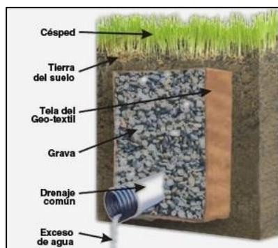
Figura N° 8: Constitución de un dren drenante
