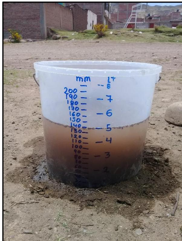
Fotografía N° 6: Prueba de infiltracion a 140 mm.
