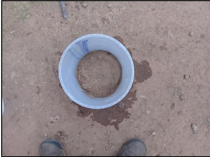
Fotografía N° 3: Puesta del elemento de medida para el ensayo de infiltración.
