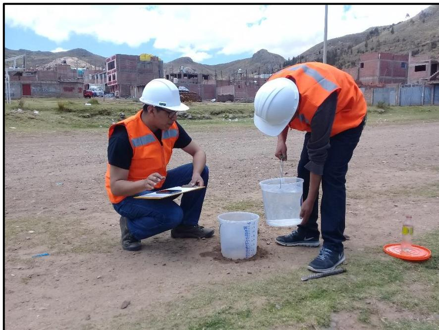
Fotografía N° 4: Incorporación de agua para medir la infiltración.
