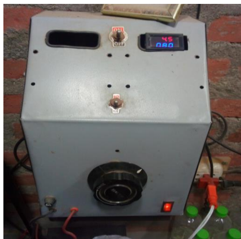
Figura 10: Rectificador de corriente. Fuente: Toma de imagen propio.
