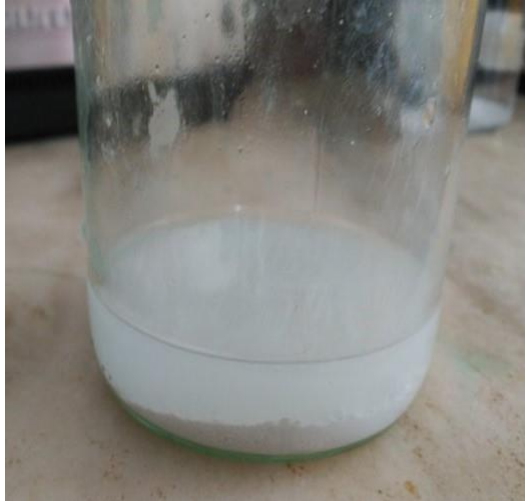
Figura 13: Precipitación con cloruro de plata
