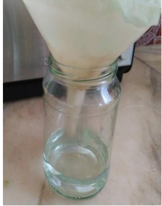
Filtrando la solución de plata después del ataque químico.
