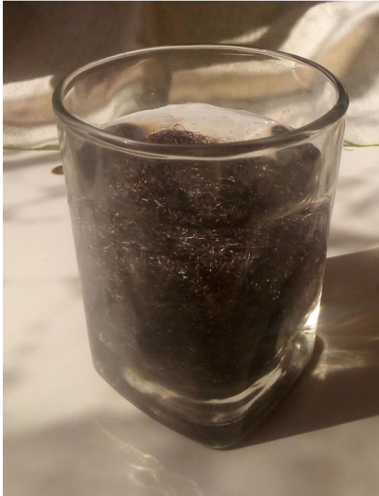
Ataque químico con ácido nítrico a la lana de acero.
