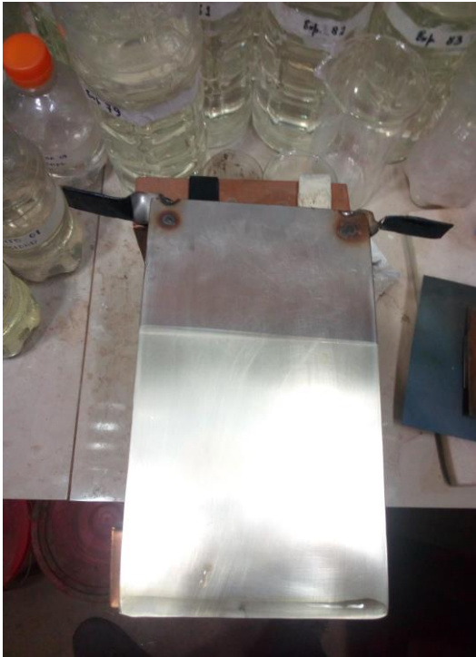
Se observa el cátodo cargado de plata después de la electrodeposición
