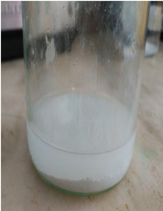
Precipitación de plata (Ag) con cloruro de sodio (sal común).
