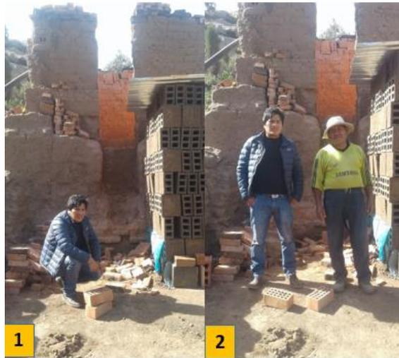
*Figura 18.* Extracción de los ladrillos del horno artesanal.
