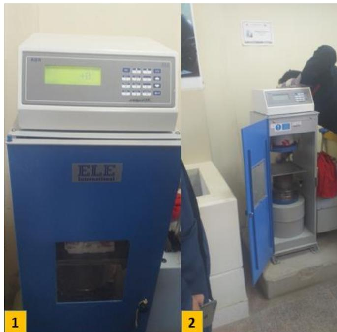
*Figura 27. Máquina de compresión.*
