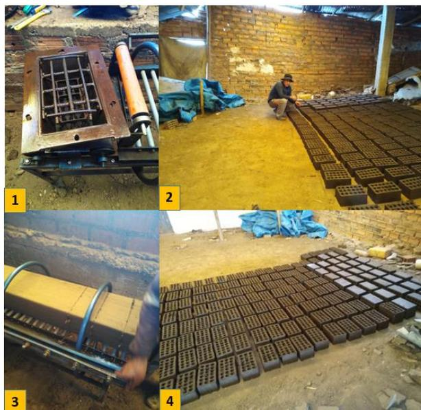
*Figura 17.* Proceso de moldeado, cortado y secado.
