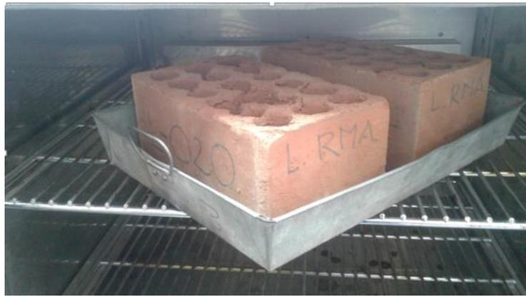
*Figura 20. Secado en horno.*
