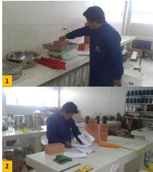
*Figura 21. Determinación del peso.*
