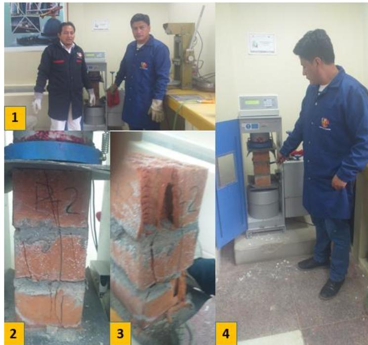
Figura 32. Rotura de pilas de albañilería.
