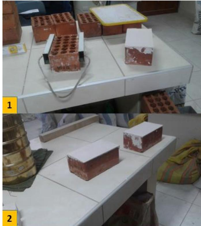
*Figura 28. Refrenado con yeso en ladrillos.*
