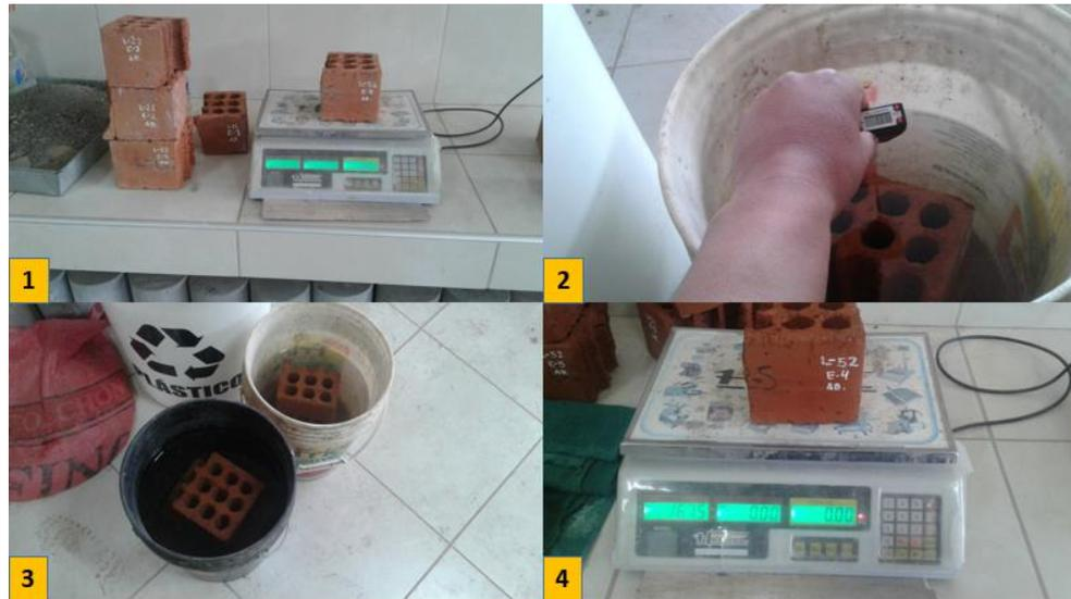
*Figura 24.* Procedimiento para medir la absorción.
