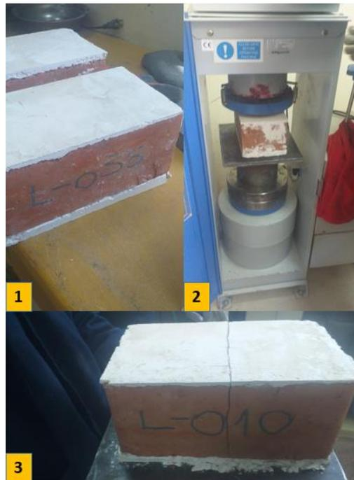
*Figura 29.* Proceso de compresión de ladrillos.
