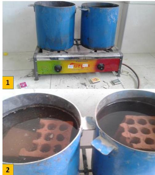
Figura 25. Procedimiento para la absorción en agua caliente.
