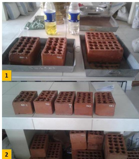
*Figura 26.* Ladrillos separados por pares para determinar la eflorescencia.
