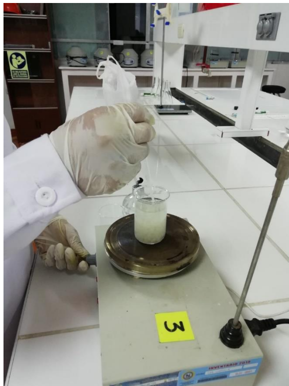
Figura 49. Encapsulamiento en perlas de alginato de calcio
